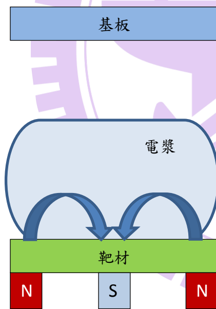
圖 2-11 磁控濺鍍原理示意圖
