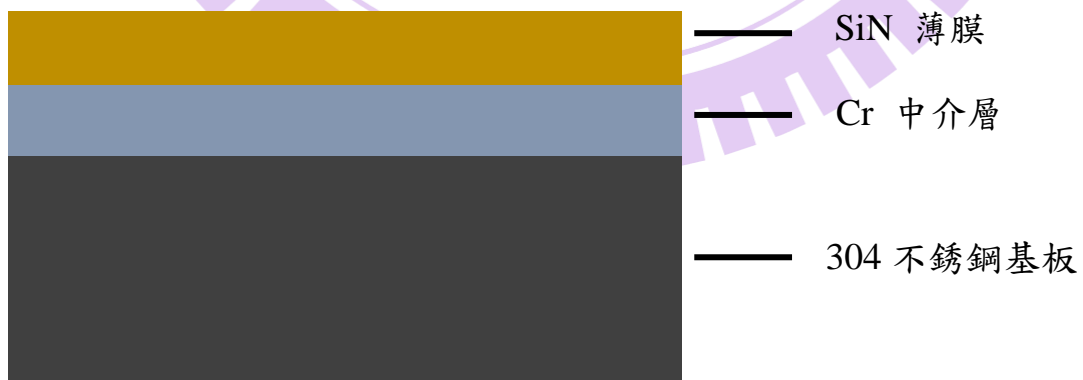
圖 4-16 SiN 薄膜中介層示意圖
