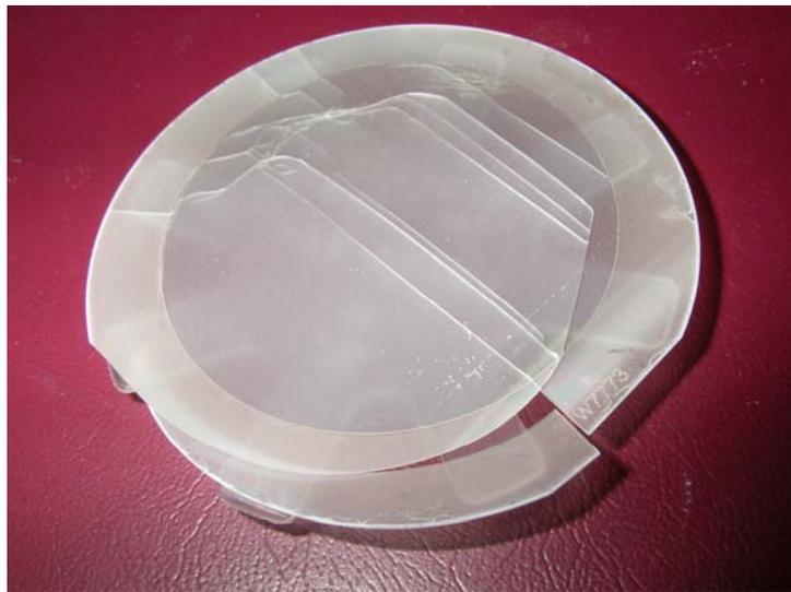
圖 2-2-1 由於熱膨脹係數的差異，在降溫過程造成晶片龜裂
