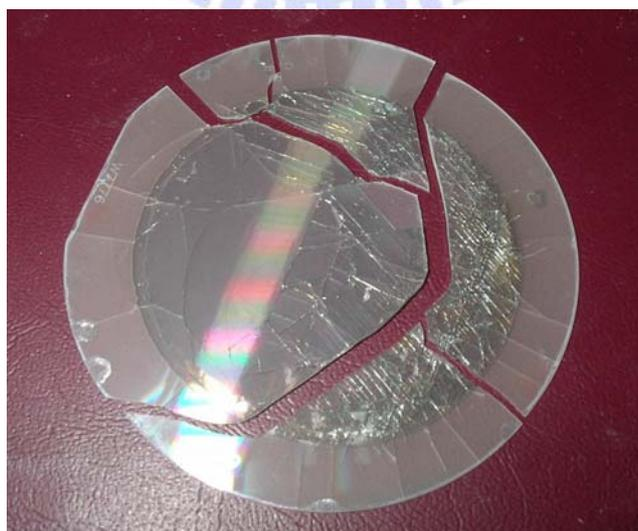
圖 4-3-1 從成長溫度 1050°C 降回室溫時，晶片碎裂
