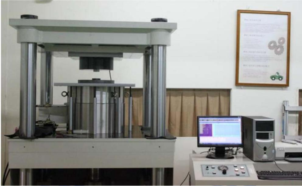
圖 4.1 高液壓成形機台
