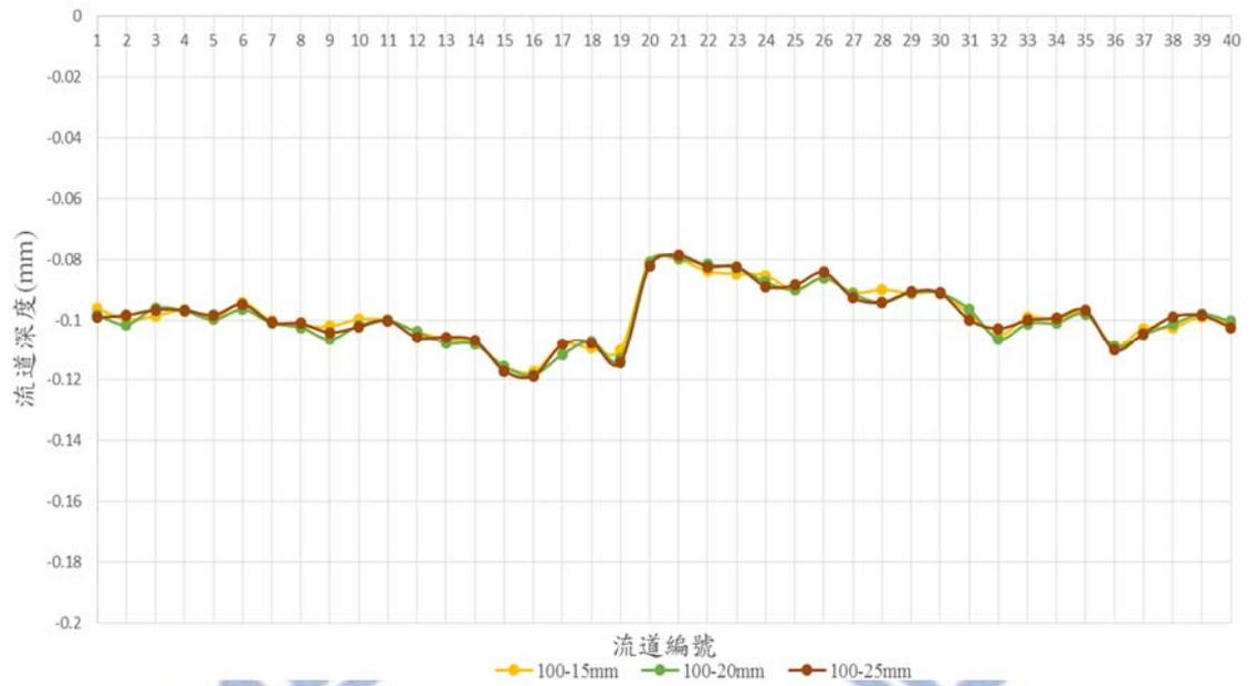
圖 4.30 液壓力 100MPa 之新模具流道深度分布模擬結果
