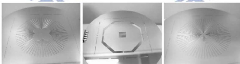
圖 1.8 氣體流道(左)、中層隔板(中)、液體流道(右) [7]
