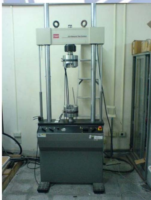
圖 3.1 MTS-810 拉伸試驗機
