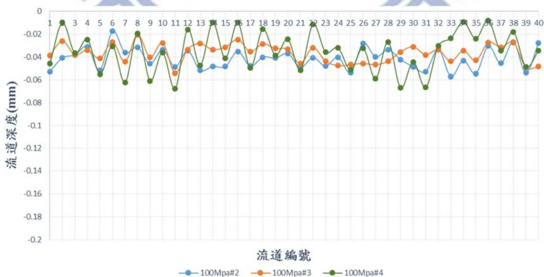
圖 4.23 液壓力 100MPa 成形實驗之流道深度分布結果
