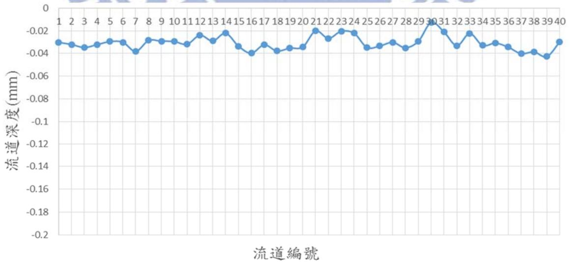
圖 4.33 液壓力 100MPa 流道深度分布實驗結果比較(新模具)
