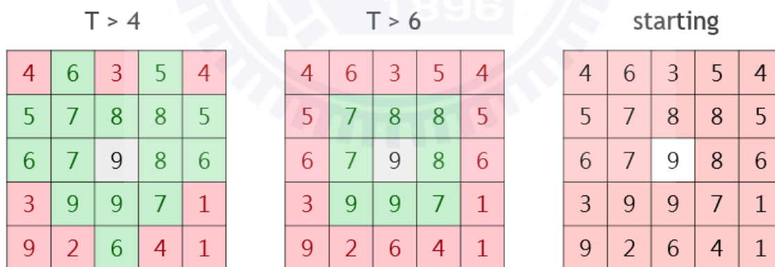
圖 8: 區域成長法示意圖。(右)為起始狀態，中央為起始點(白色 9)。
