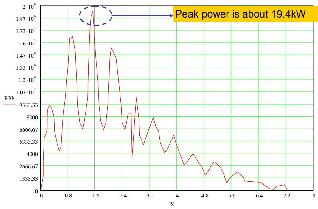
圖 5.2-7 利用圖形的 fitting，找出鎖模實際上的峰值功率。
