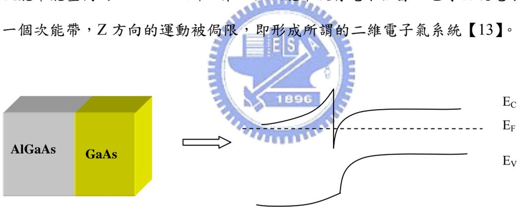
圖 2-1 GaAs/AlGaAs 的異質接面結構。
