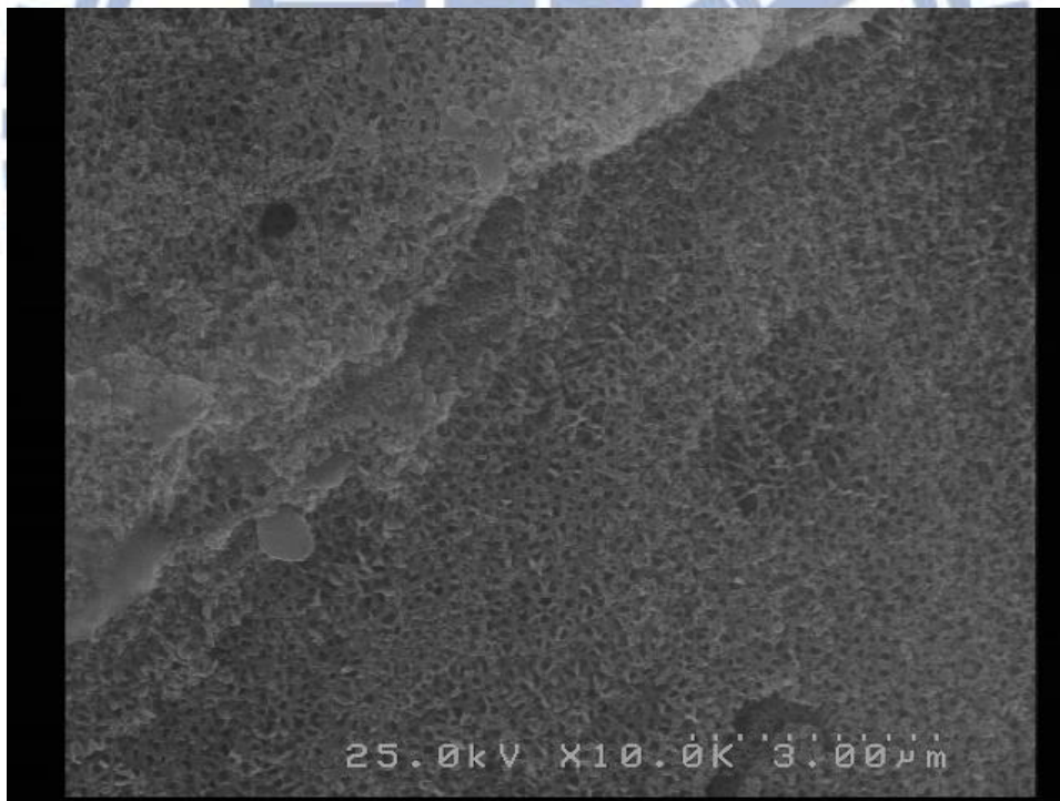
圖 4.3.2 陽極電壓 100V x10000 之表面
