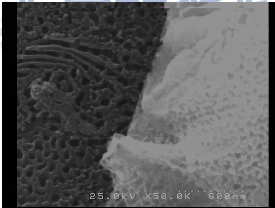
圖 4.7.9 ABS 薄膜與陽極孔洞接合 x50000
