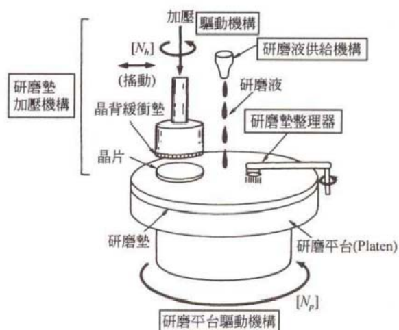
圖 23 化學機械研磨示意圖
