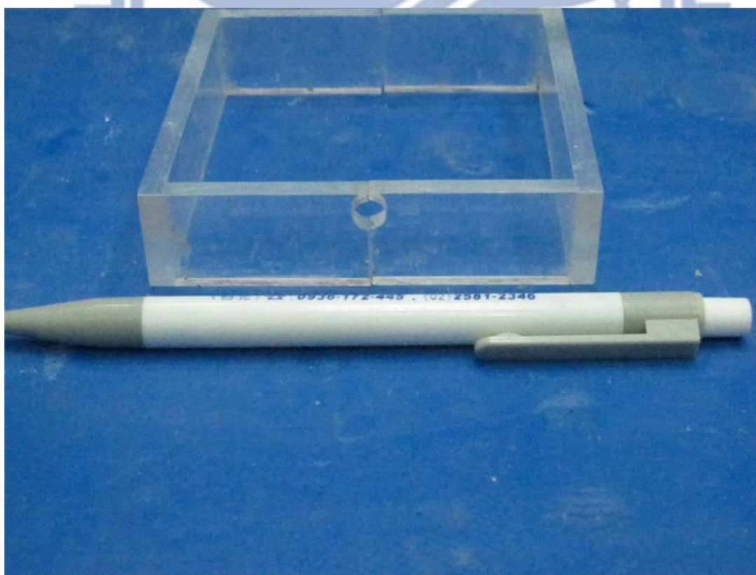
圖 5-3 模擬噴氣工法直剪試驗混凝土下盒之製作模具
