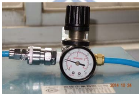
(e) 調整噴流孔之空氣壓力
