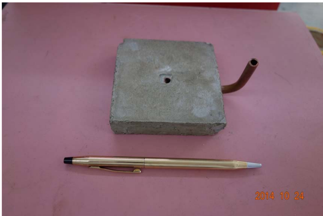
圖 5-2 附外徑 3mm 銅質噴氣管及噴氣口之混凝土下盒試體
