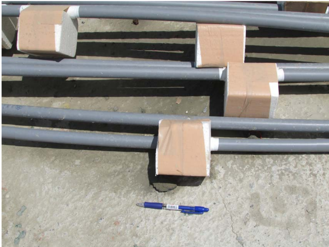
圖 4-22(a) 噴流管上預留氣體噴射管道的保麗龍塊
