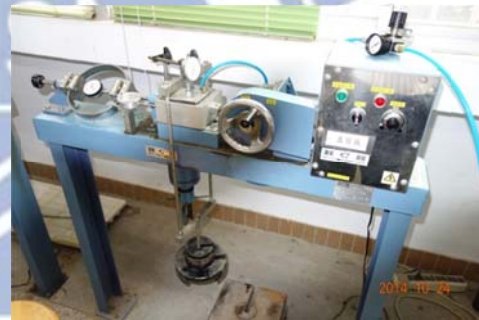
(d) 放置垂直荷重加壓載具、水平及垂直位移計並接上空氣噴流管
