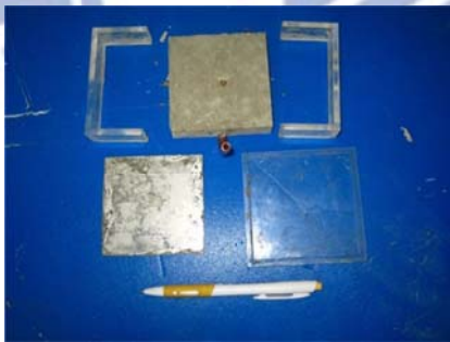
(e) 噴氣混凝土下盒 試體完成
