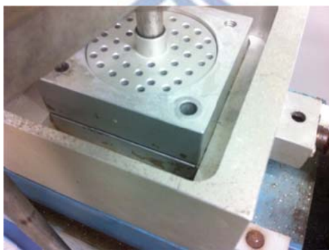
(e) 以螺柱將上下剪力盒頂開後，開始直剪試驗
