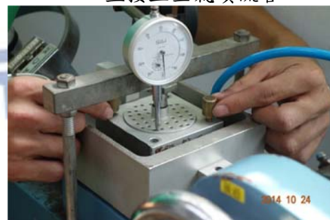
(f) 以螺柱將上下盒頂開後，開始直剪試驗
