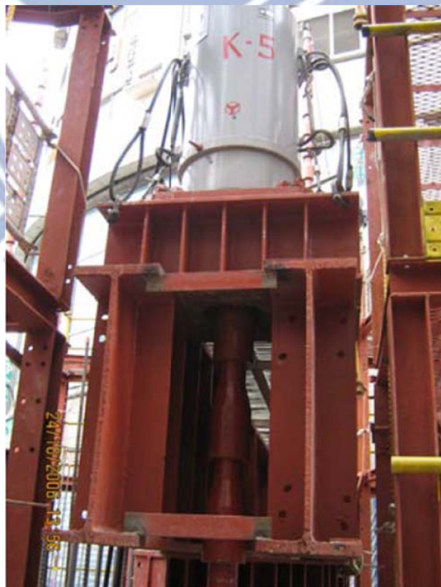
圖 2-8 竹節形夾棒連結至千斤頂 (圖摘自台北市政府捷運工程局，2008)
