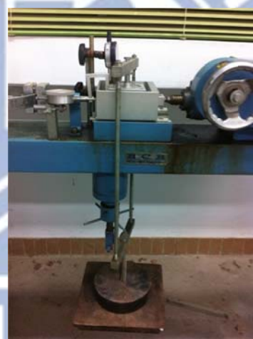
(d) 安裝測微計及加載垂直荷重
