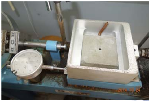
(a) 置入有埋設噴氣孔之混凝土
