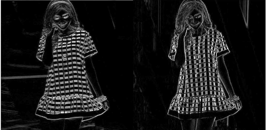
圖 3.1.5 分別為水平邊緣偵測(左)與垂直邊緣偵測(右)之結果
