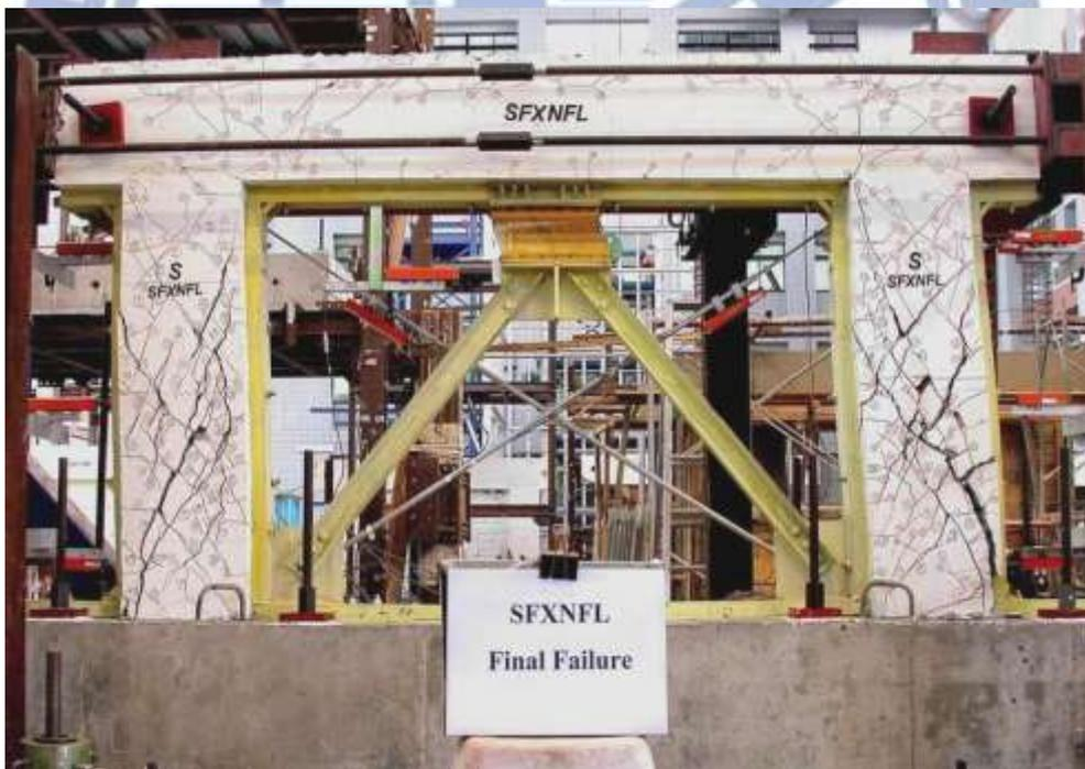
圖 2.23 SFXNFL 試體之試驗結果[3]
