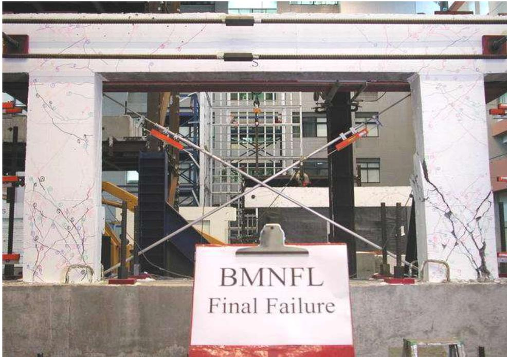
圖 2.20 BMNFL 試體之試驗結果[3]
