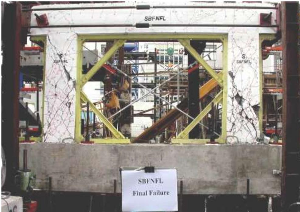
圖 2.22 SBFNFL 試體之試驗結果[3]
