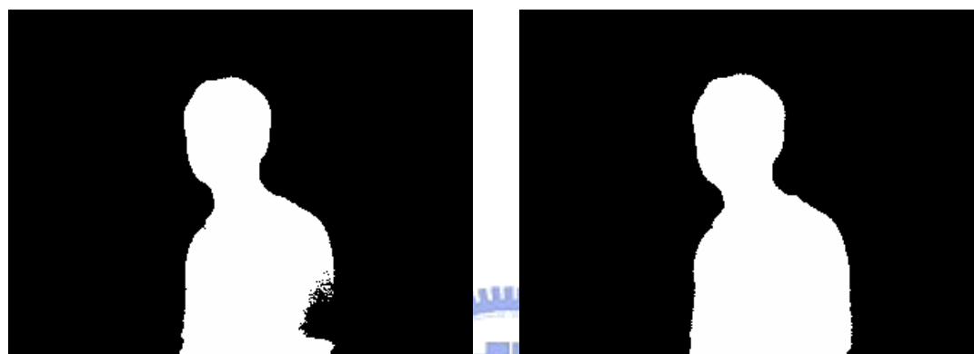
(a)環境溫度攝氏 22 度，固定 T_{Thr} (b)環境溫度攝氏 22 度，自動調整 T_{Thr}
