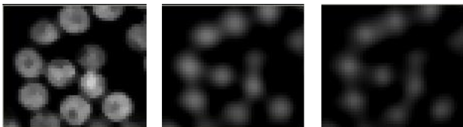
圖 4-2 :(左)原始影像 (中)利用 Gaussian distribution 的 mask 處理後的結果 (右)利用五顆細胞所設計出來的 mask 處理後的結果
