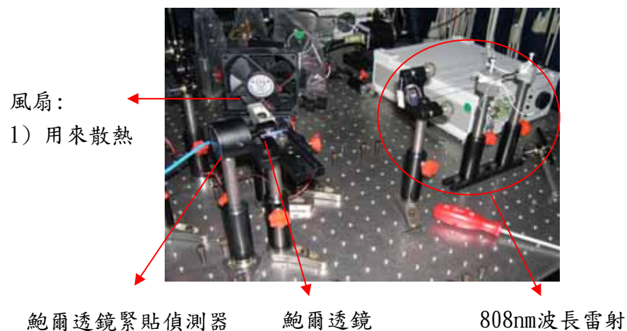
圖3-24：量測鮑爾透鏡功率容忍度實驗裝置
