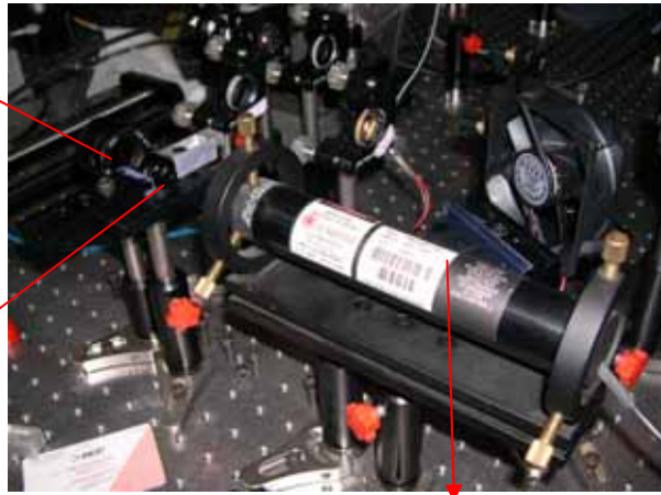
圖3-27：測量鮑爾透鏡對氬氬雷射穿透率的實驗裝置圖
