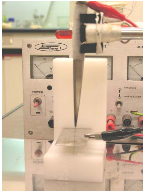
圖 3-5(a)：利用電化學蝕刻法製作探針時所使用的裝置。
