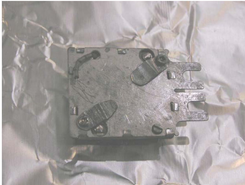
圖 3-2：可進行樣品交換的樣品平台。
