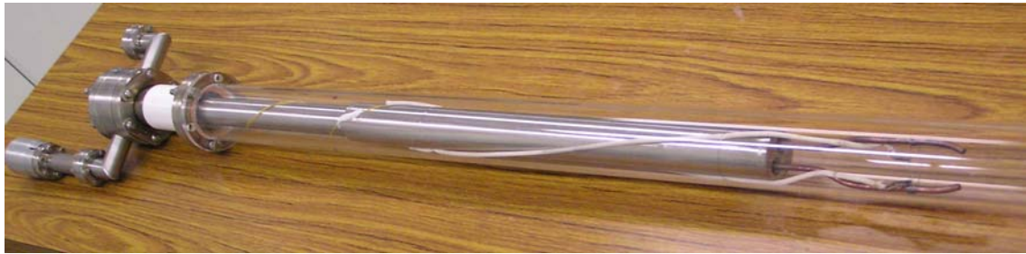
圖 3-4(a)：中空不銹鋼管的樣品平台。
