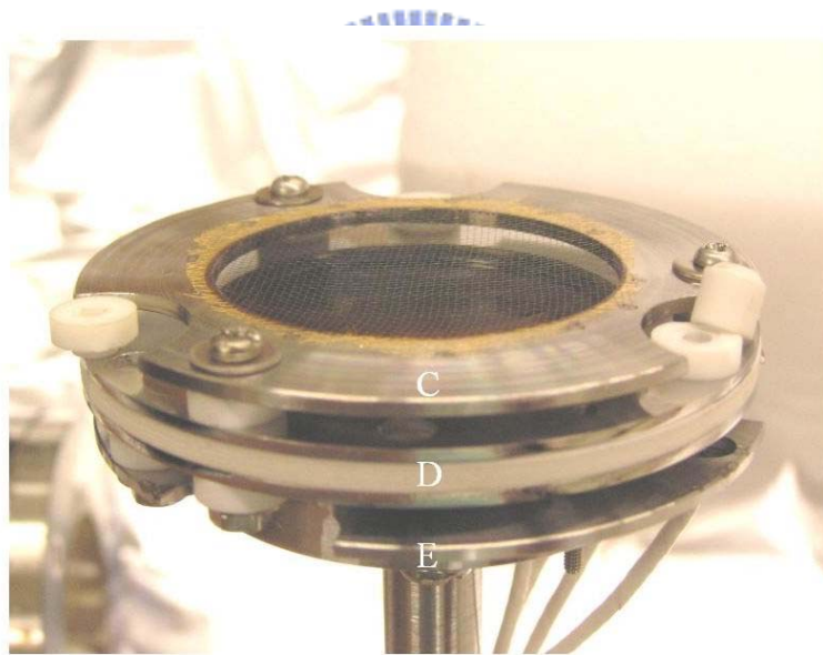
圖 3-12：電子產率偵測器構造示意圖與實物。
