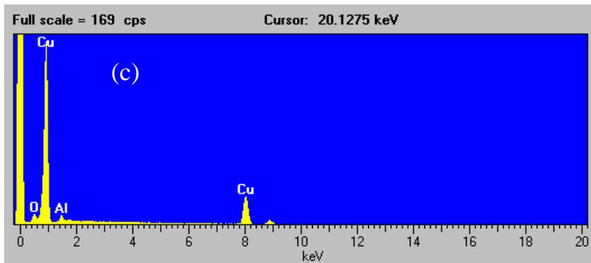
圖一 以去離子水為溶劑時所產生的樹狀銅(樣品 A1) (a)側視角 SEM 影像 (b)俯視角 SEM 影像圖 (c)圖(b)樹狀結構之能量分散光譜圖 (EDS)
