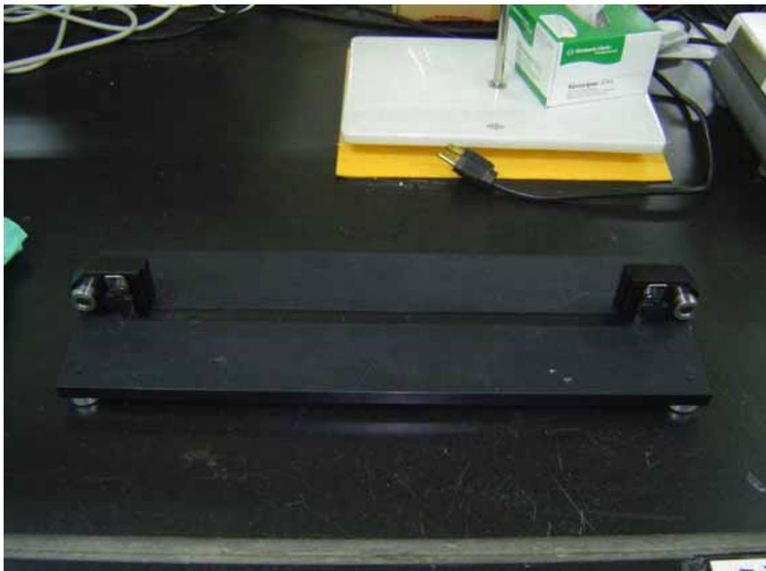
圖 19、毛細管固定架
