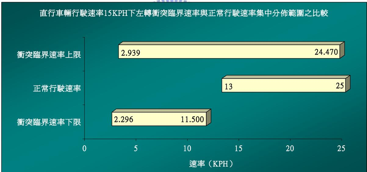
圖 5.49 直行車輛速率 15KPH 下左轉衝突臨界速率與正常行駛速率集中分佈範圍之比較圖
