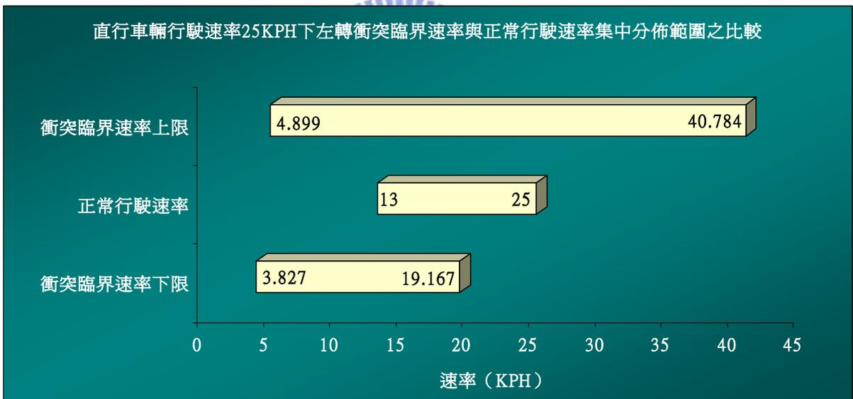
圖 5.51 直行車輛速率 25KPH 下左轉衝突臨界速率與正常行駛速率集中分佈範圍之比較圖
