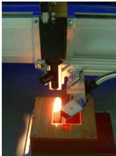
圖 3.12 側照式光纖光源系統之原型
