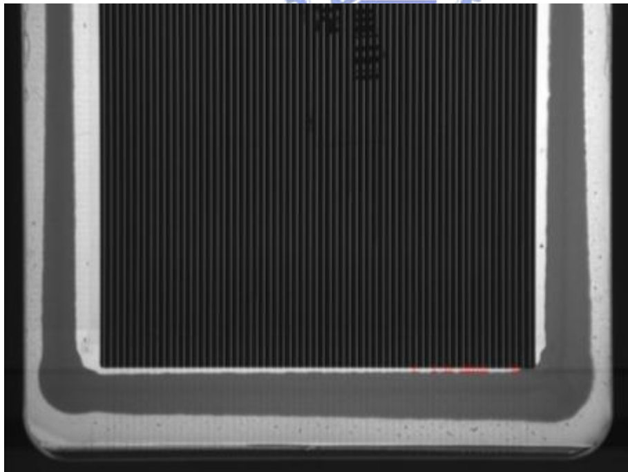
圖 4.22(a)內膠與陰極過窄檢測結果
