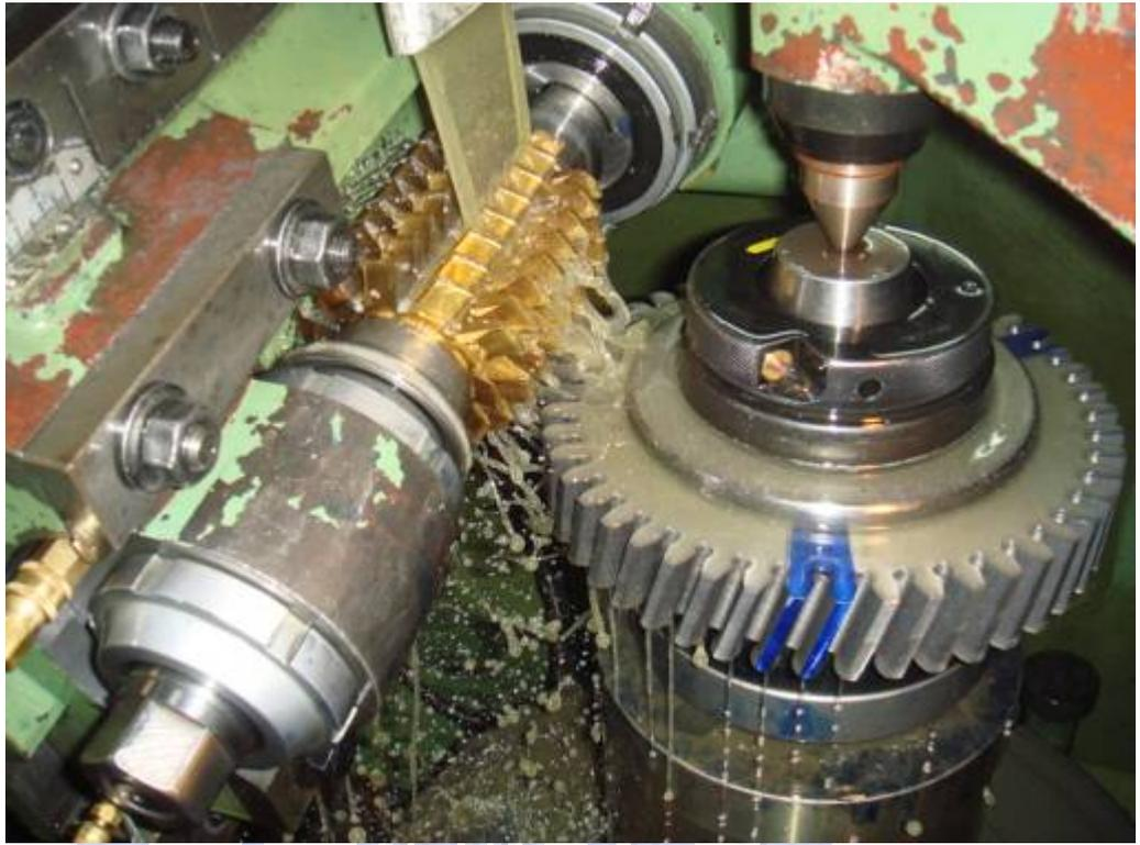
圖 3.16 滾製刮齒刀齒形
