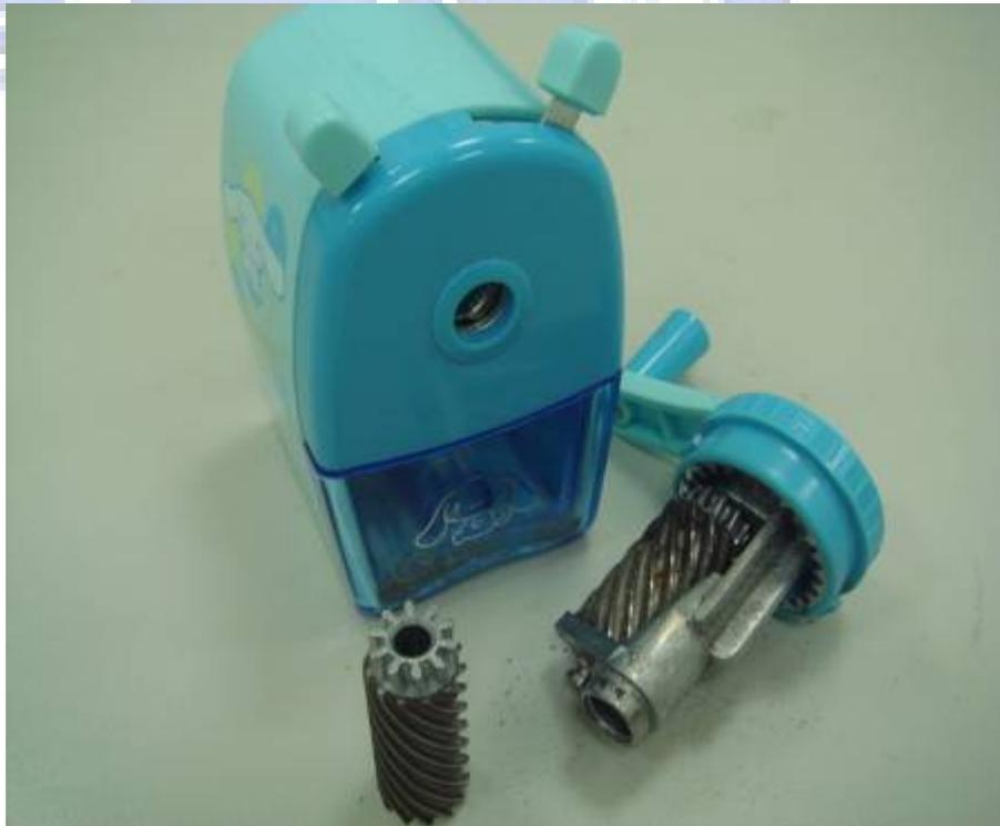
圖 3.27 削鉛筆機與負向角齒形刀具
