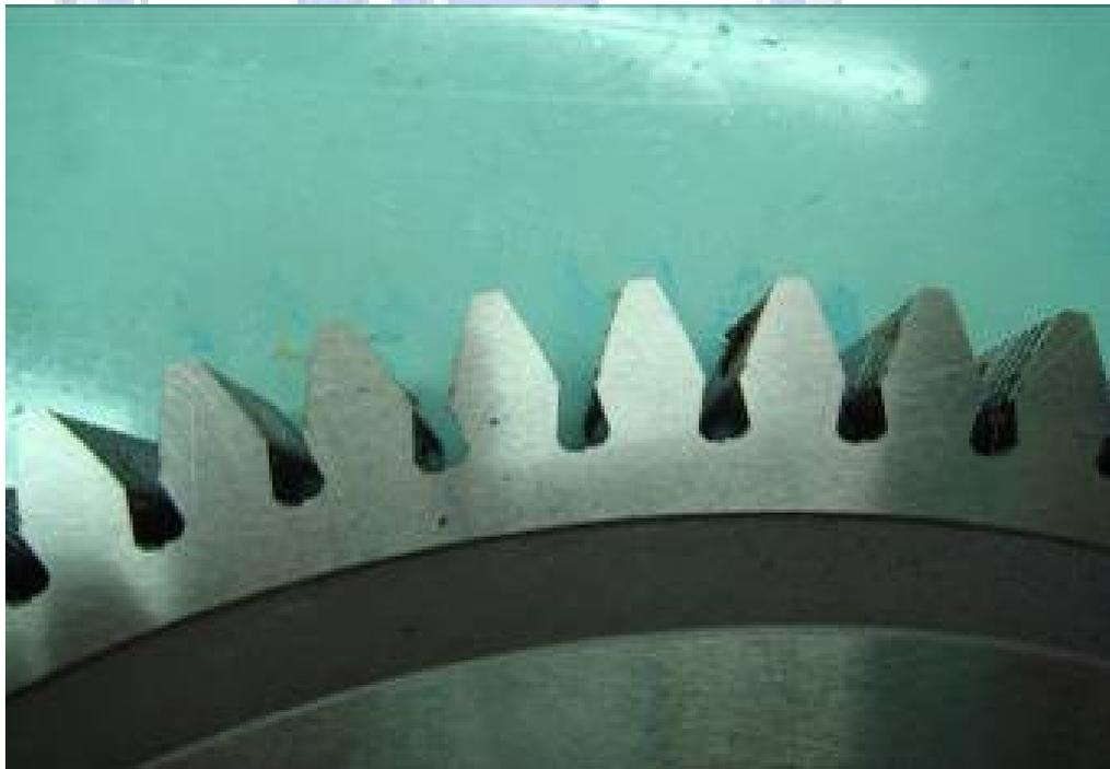
圖 4.2 傳統銑製刮齒刀齒根讓槽
