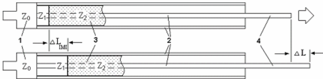
圖 2-3 界面形式原理—人造界面所構成時域反射伸縮計
