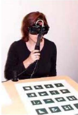
圖 3-15 手持式顯示器及識別標誌(Gordon, et al. 2002)
