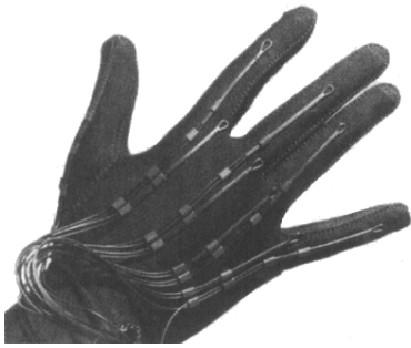
圖 2-1 VPL 的資訊手套藉由沿著手指和大拇指的一條纖維光學鋼繩來測量手指彎曲時的信號衰減，並以此來偵測手指的動作 (摘自 MacKenzie, 1995)
