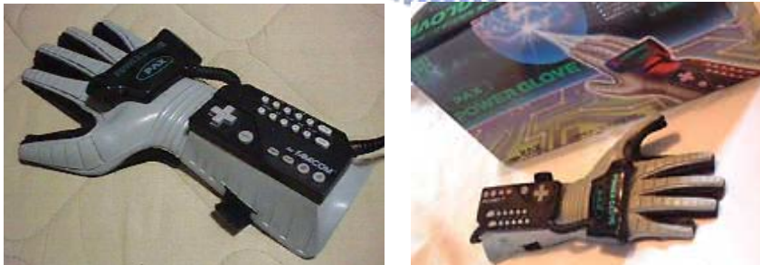
圖 2-3 任天堂公司的Power Glove則是利用超音波感測方式來做 3D 定位追蹤 (摘自 http://www.vidgame.net/NINTENDO/powerglove.html )
