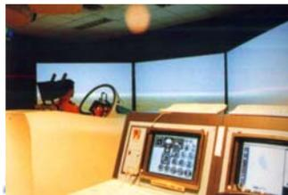
圖 2-10：模擬機的視效系統[摘自飛行訓練指揮部模訓組,民 82]
