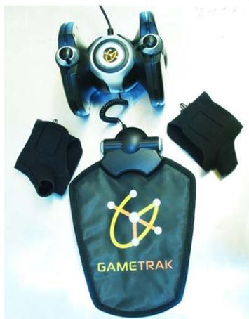
圖 2-7：Gametrak 的遊戲設備：左右兩個黑色是手套，玩家直接帶在手上，用來追蹤手的動作；中間的方塊是踏墊，用來反應腳的動作。[摘自 In2Games, 2004]
