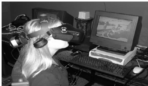
圖 2-1：受測者穿戴頭戴式顯示器以及頭戴式追蹤裝置體驗模擬飛行[摘自 McKinnon & North, 2004]
