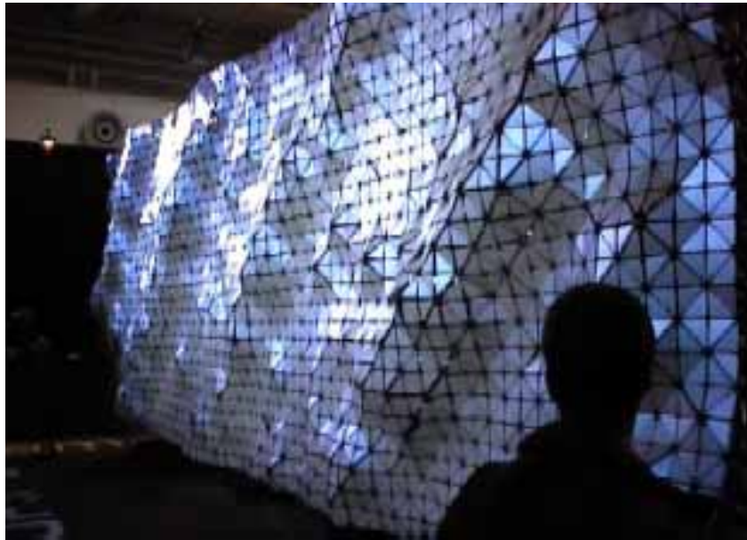
圖 10： Aegis Hyposurface 機械感應牆面透過聲音訊號自動感應(More, et al. 2002)。
