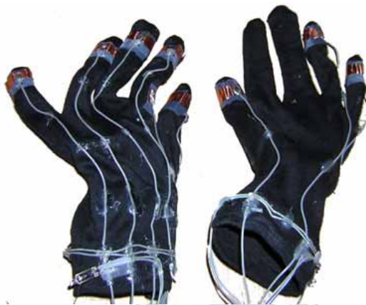
圖 42：將搖桿訊號透過感應器與 JOYTOKEY 軟體轉至手部操作。
