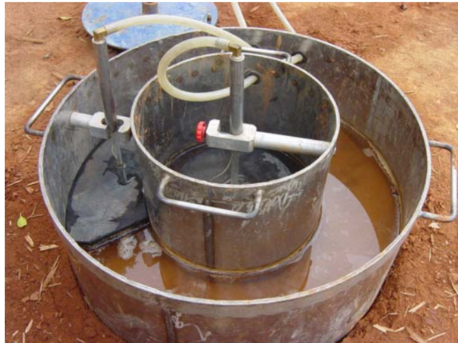
圖 3.6 Double-Ring Infiltrometer 儀器架設完成圖
