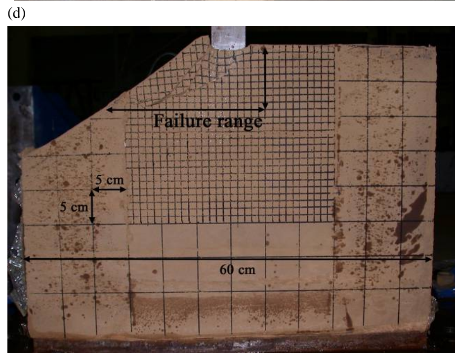
照片 5.7 試體破壞後照片(a)No. 0°-3 (b)No.10°-2 (c) No.20°-2 (d) No.30°-1 (e) No.20°/1B-3 (f) No.20°/2.5B-1
