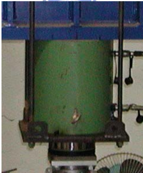
照片 3.2 (a) 5HP 電動油壓泵 (b) 400 噸雙動型實心式油壓千斤頂
