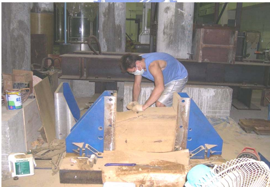
照片 4.5 刮尺修整試體
