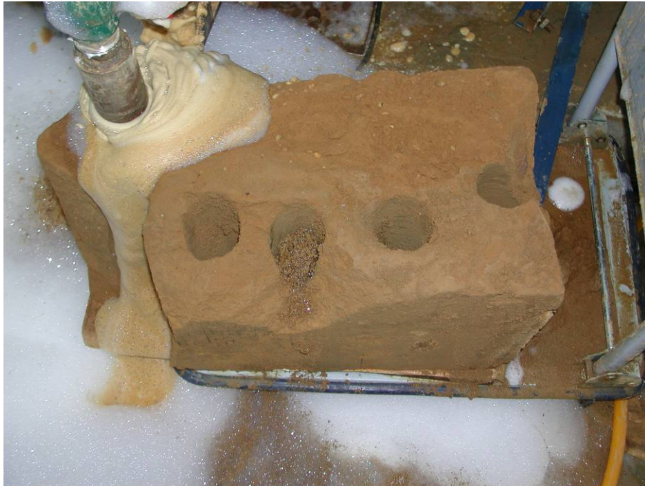
照片 4.10 泡沫鑽心取樣照片
