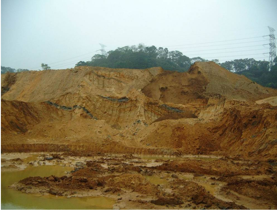
照片 4.1 新竹縣寶山第二水庫工址處砂岩層邊坡
