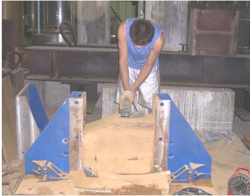
照片 4.6 磨平機修整試體表面
