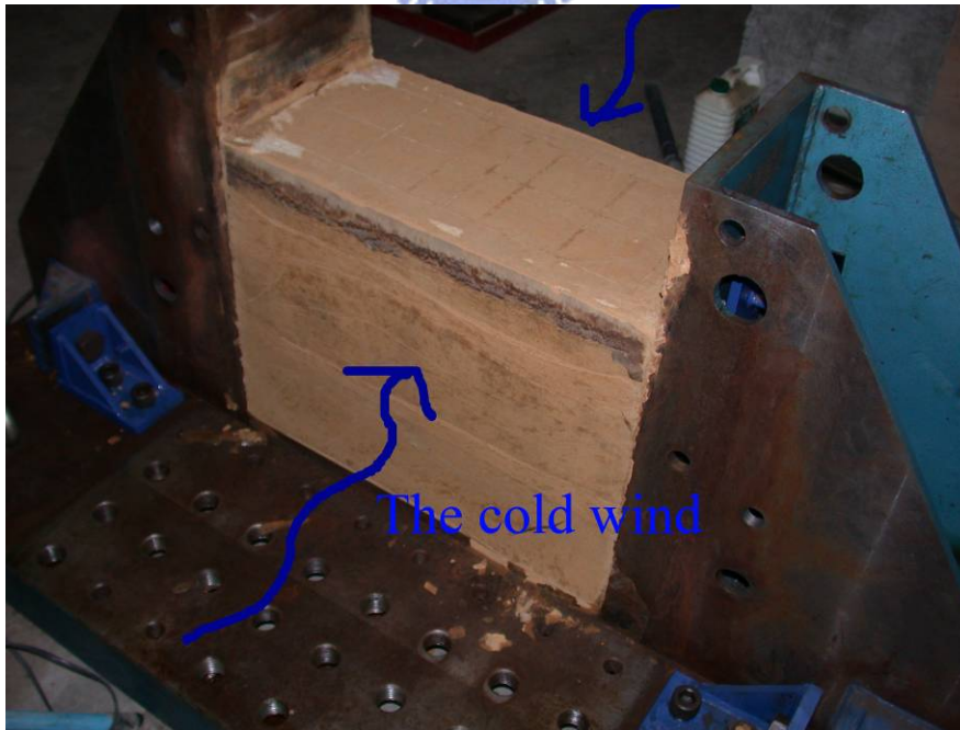
照片 4.3 試體氣乾養治情形
