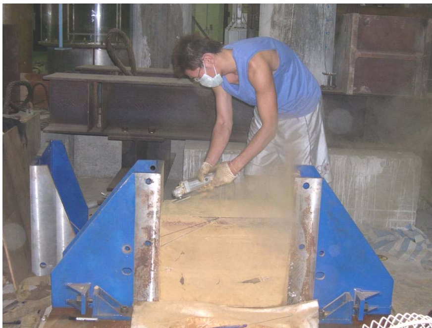
照片 4.4 砂輪機修整試體邊坡
