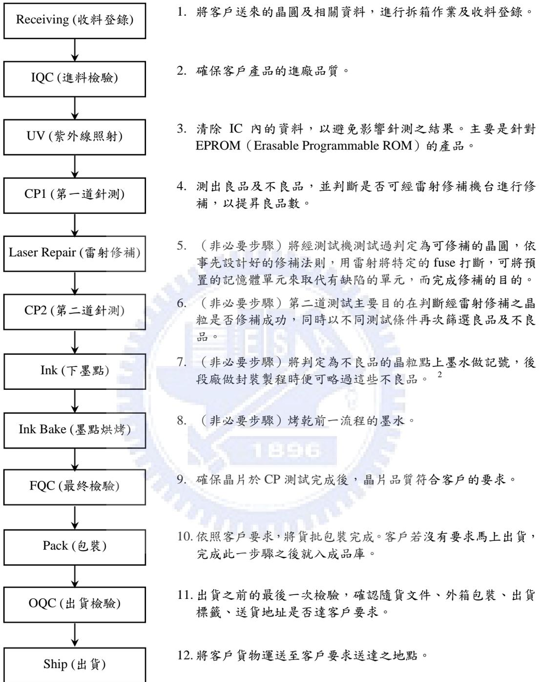
〈圖 8〉CP 測試流程
