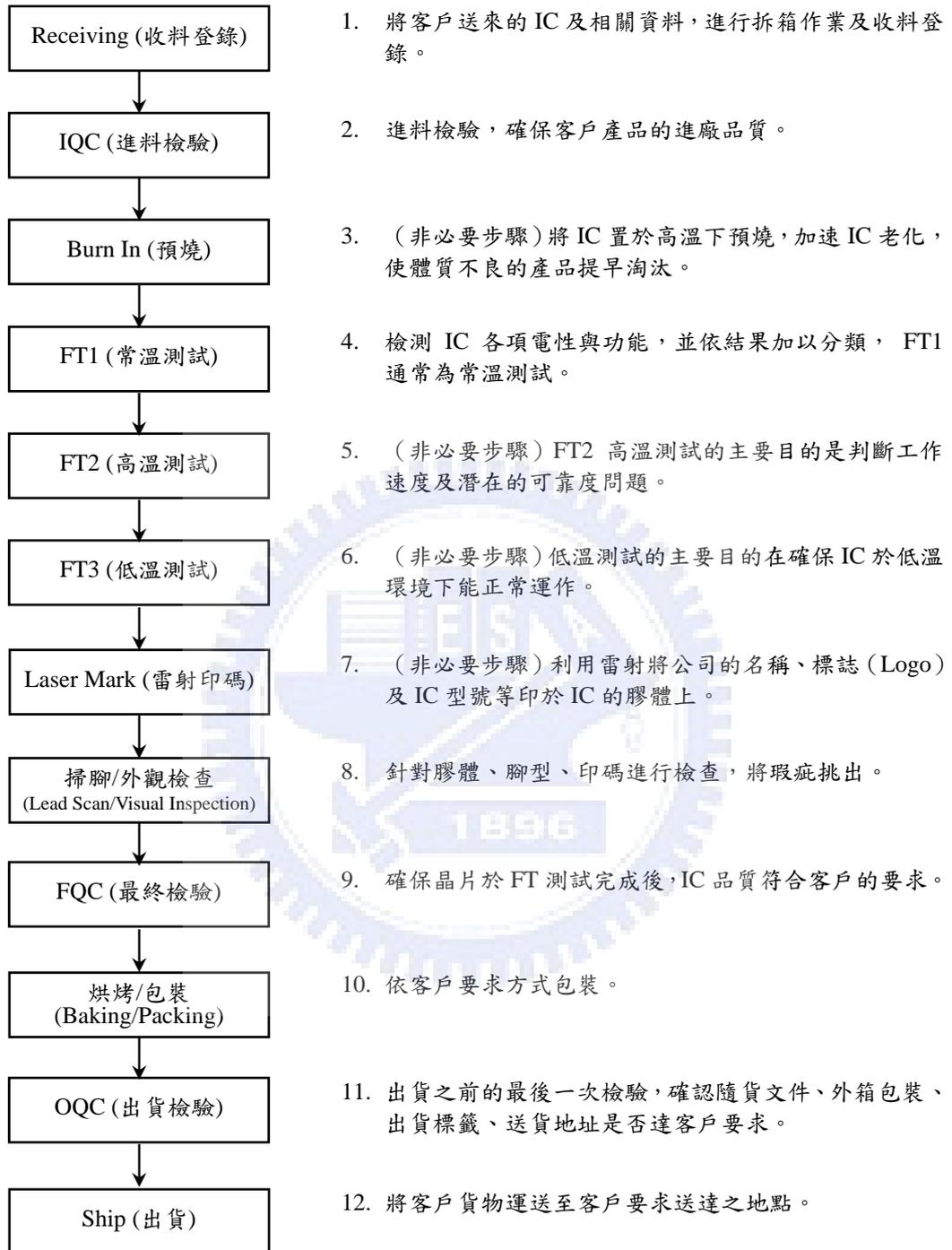
〈圖 9〉 FT 測試流程
