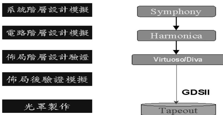
圖 6. 單片微波設計流程
