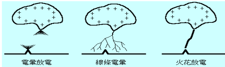
圖 2-3 電暈放電發展至火花放電之過程
