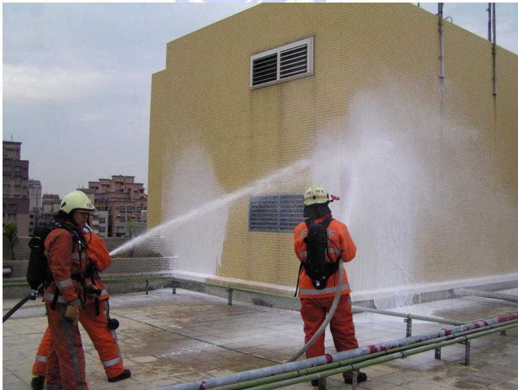
圖 4-2-8 運用高壓空氣泡沫滅火系統進行搶救示意圖
