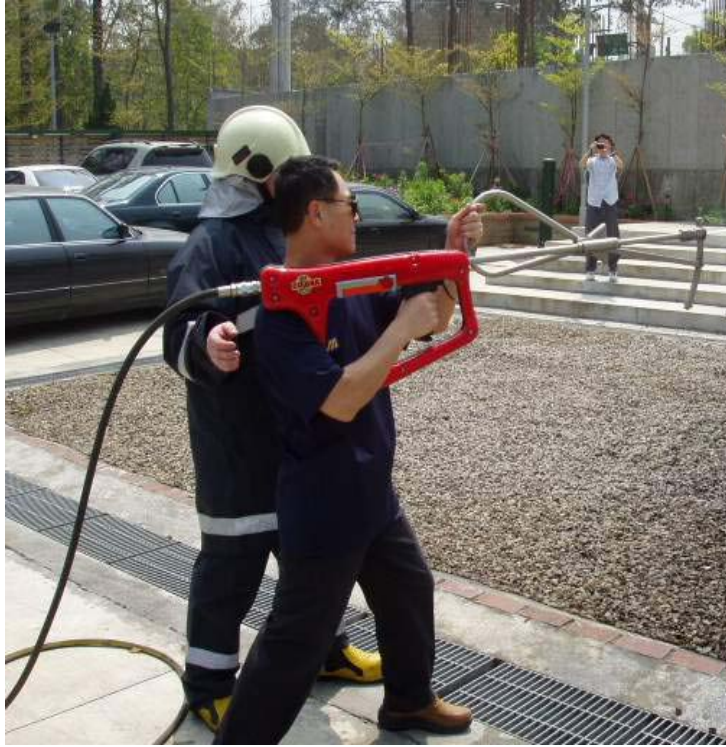
圖 4-2-10 超高壓冷卻切割滅火系統示意圖
