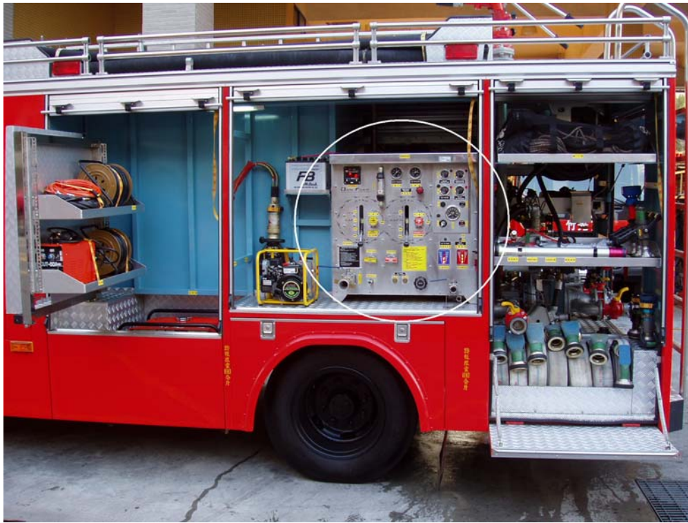
圖 4-2-7 CAFS 設備結合水箱車配置發揮救災功能示意圖
