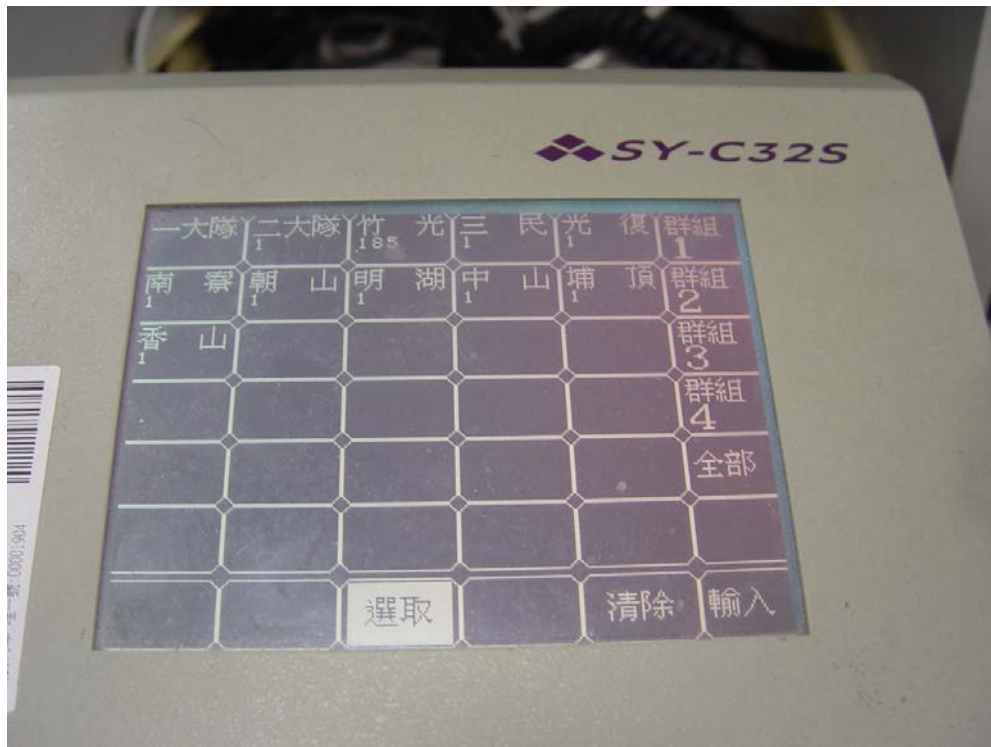
圖 4-2-1 多向指令電話系統設備操作面板圖
