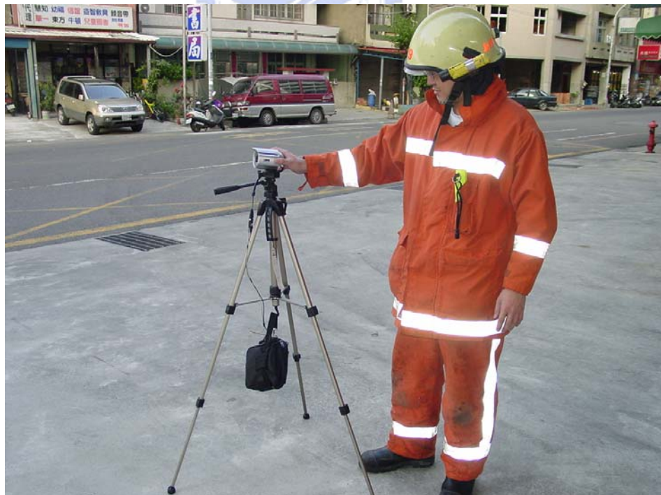
圖 4-2-4 救災現場畫面用 3G 無線方式傳輸示意圖
