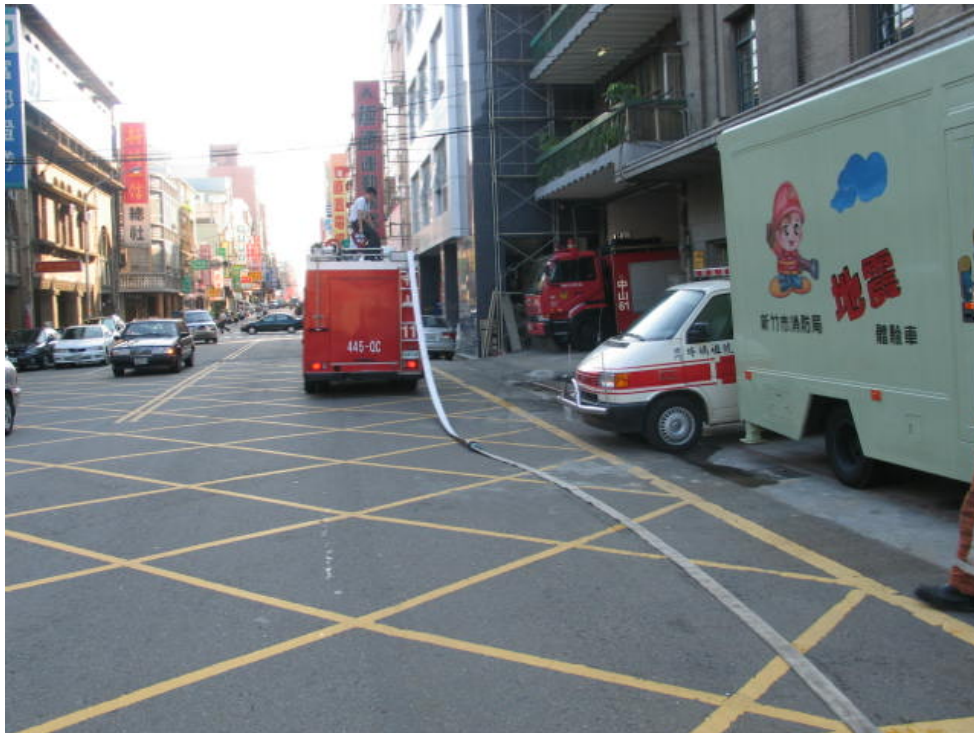
圖 4-1-3 先鋒車裝設快速水帶佈線架使用示意圖
