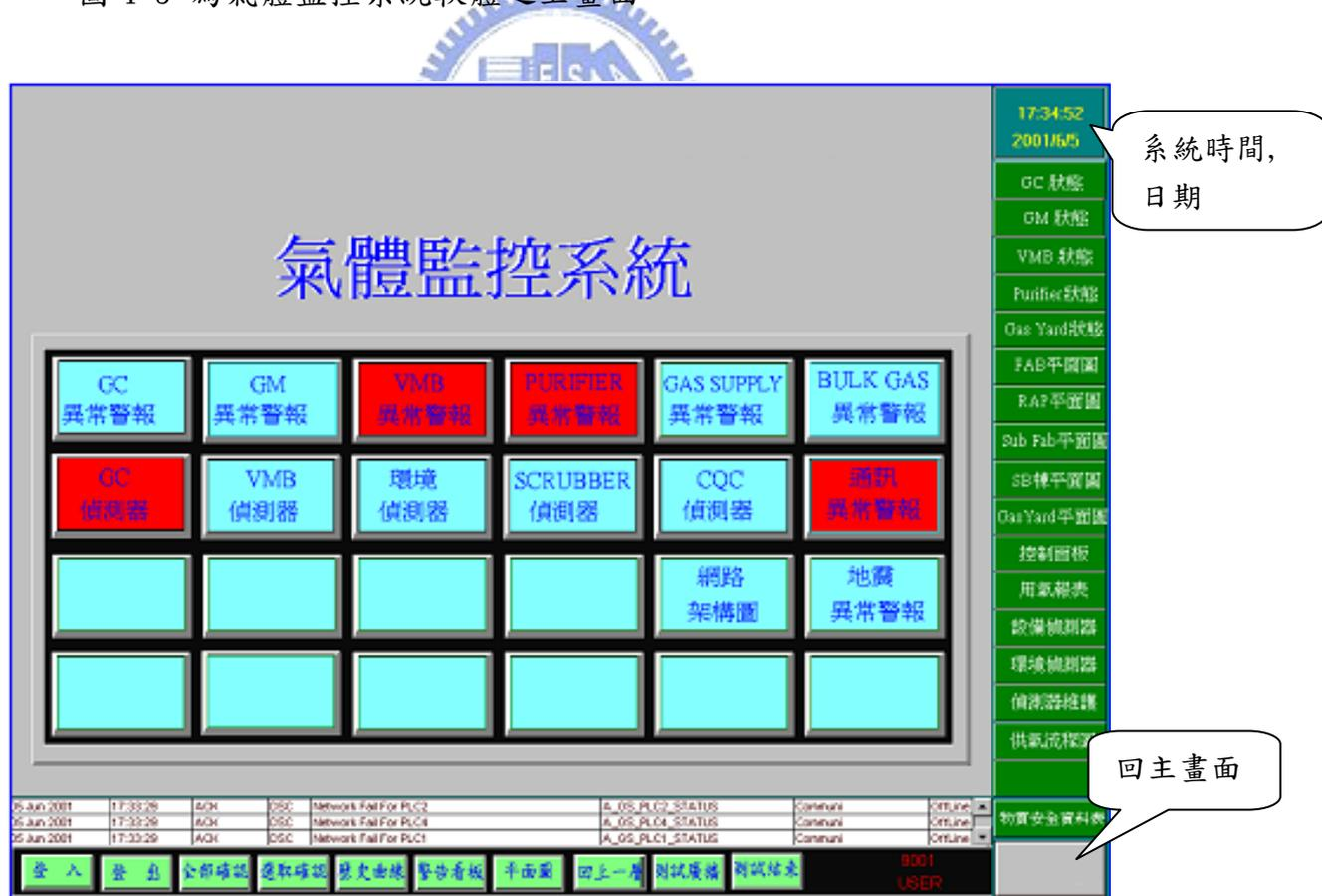
圖 4-5 GMS 氣體監控系統主畫面
