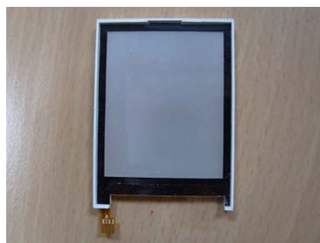
圖 41 使用直流驅動的白光LED當背光源
