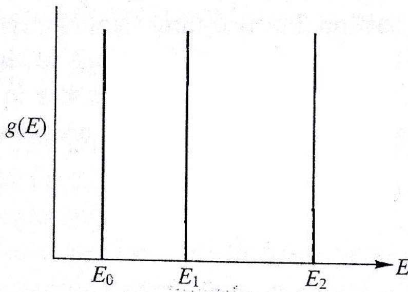
圖八 零維電子氣的能態密度表示圖
