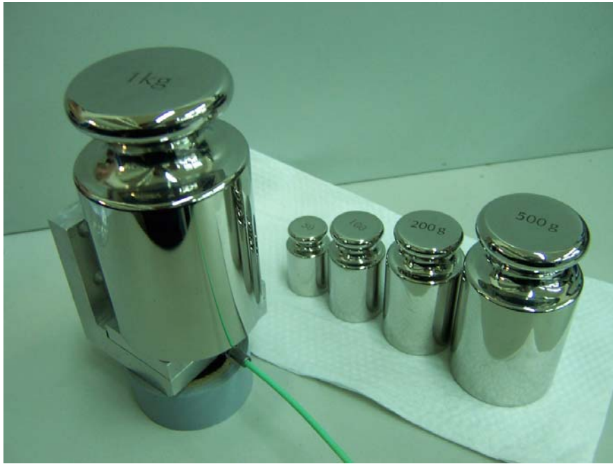
圖 2-6 使用砝碼進行校正實驗
