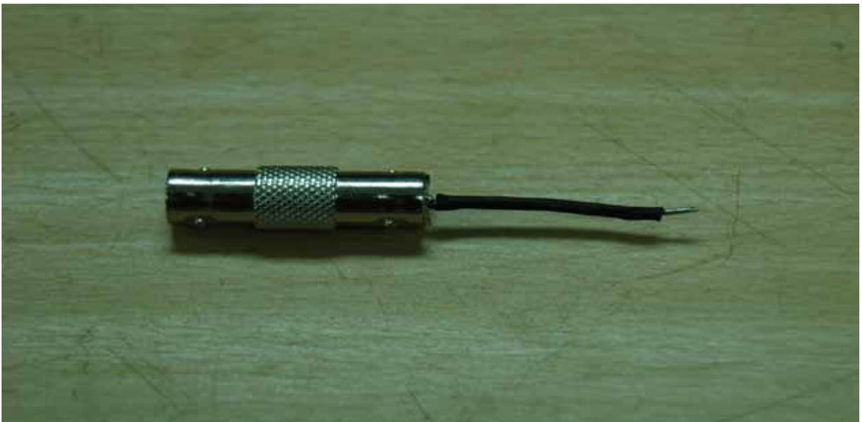
圖 2-16 自製探棒加上熱縮套管
