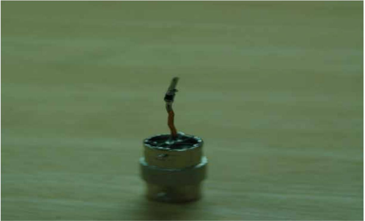
圖 2-15 自製探棒加上尖端電阻
