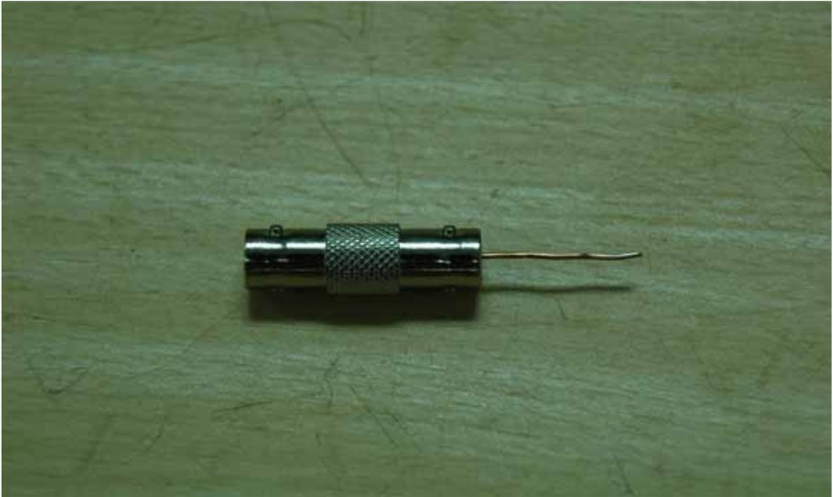
圖 2-13 自製探棒中央支柱
