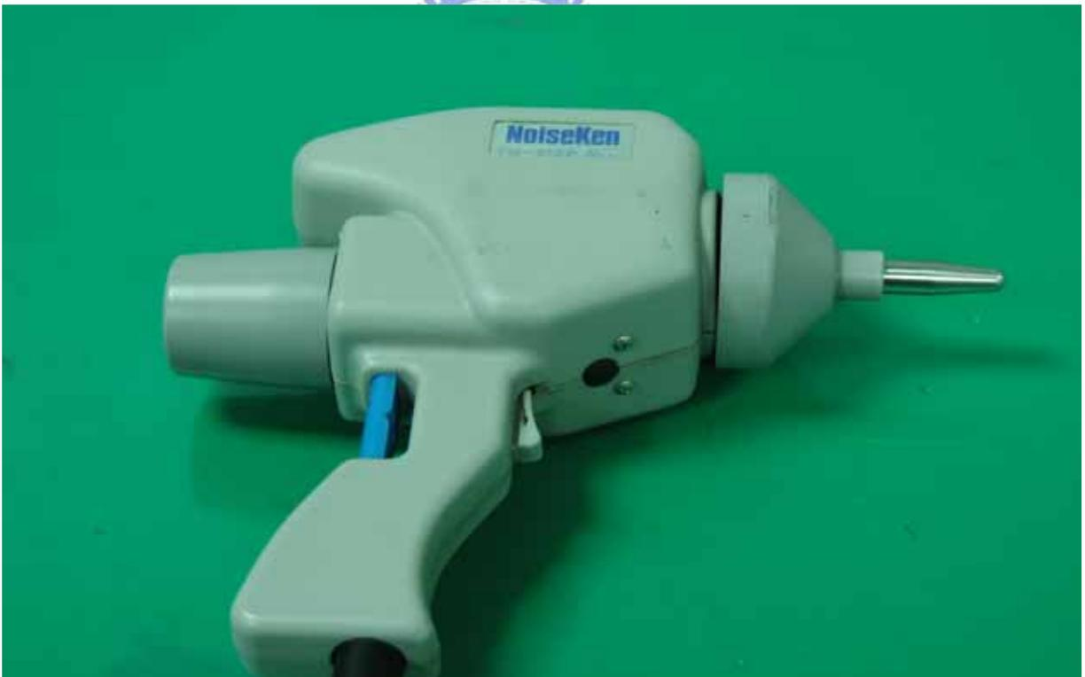
圖 3-2 NoiseKen 空氣放電器
