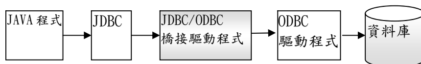
圖 7 利用 JDBC/ODBC 橋接驅動程式連接資料庫
