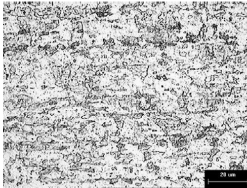
圖 4-14 BAg-3 硬鋅填料鋅片未硬鋅前之金相照片
