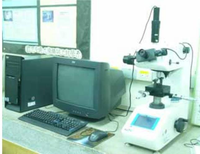
圖 3-3 微硬度量測試驗機(Matsuzawa MHT-1)
