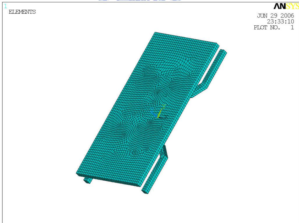
圖 2-7 平面條狀彈簧與振動板之 ANSYS 模型
