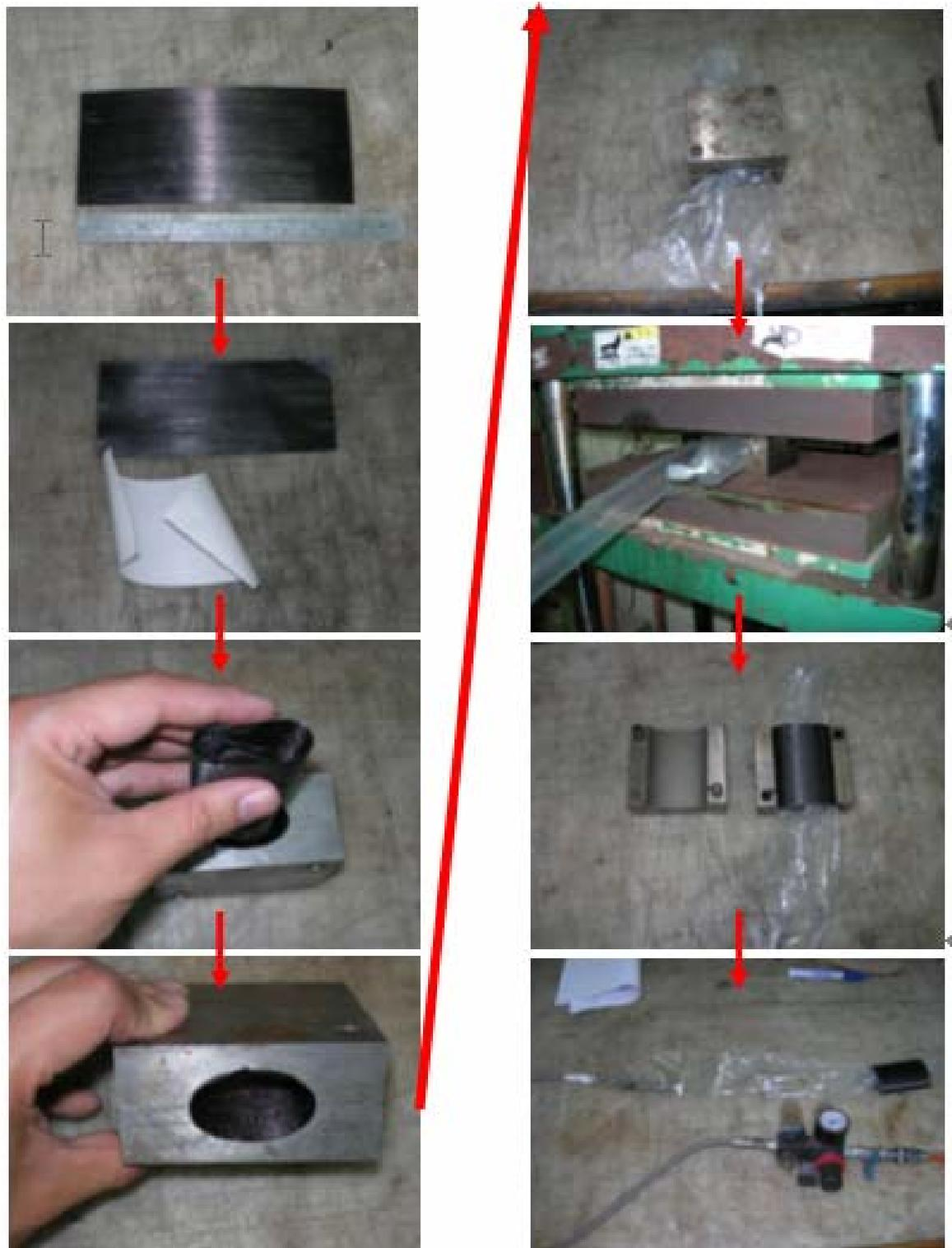
圖 3-4 內模具音圈成形法
