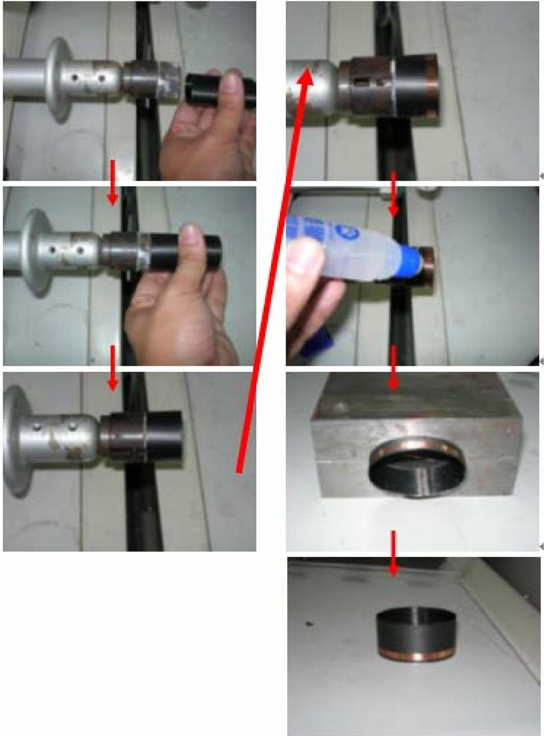
圖 3-5 音圈線圈之纏繞
