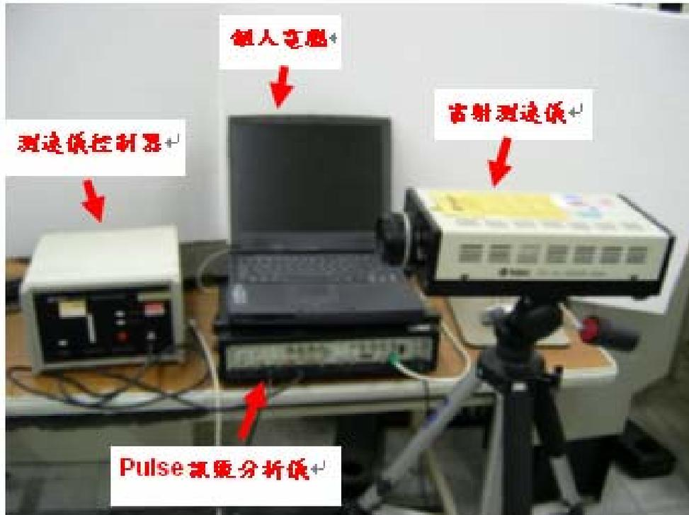
圖 4-2 雷射測速儀
