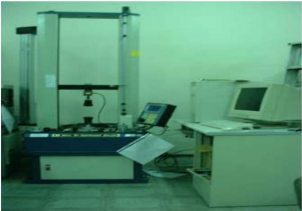
圖 4-1 弘達 HT-9102 電腦伺服控制材料試驗機
