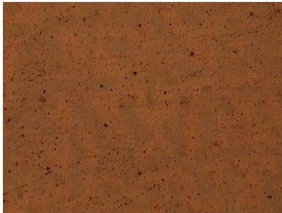
圖 4-7 試片 2 高週波溶煉後金相_500X
