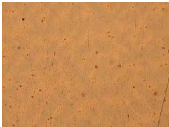
圖 4-8 試片 3 高週波溶煉後金相_500X
