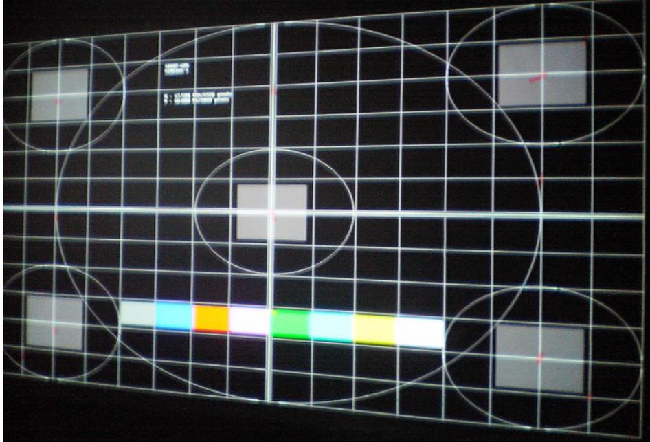
圖 4.2.12 三片式 Panel 六軸合光完成
