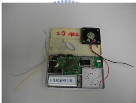
圖 2.8 PH-1 喇叭、麥克風訊號線內部連接圖
