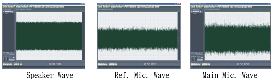
圖 3.4 PH-1 整機喇叭、麥克風聲壓-時間波形曲線圖(Noise)
