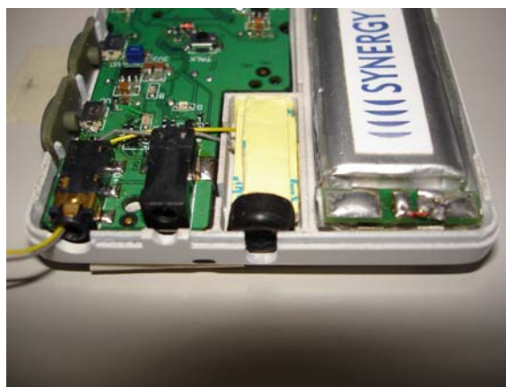
圖 2.16 PH-1 主要麥克風方向垂直 90 度標準防振橡膠墊實驗
