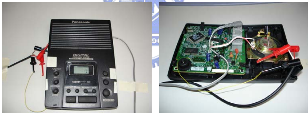
圖 2.21 電話答錄機電容及訊號線連接方法
