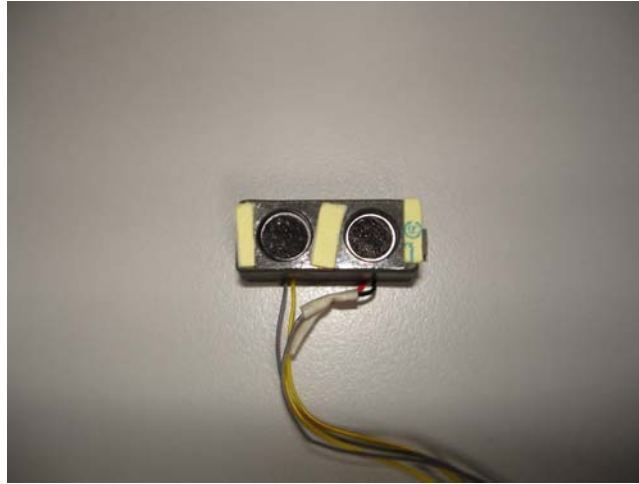
圖 2.15 PH-1 麥克風收音防振橡膠墊改善實驗一
