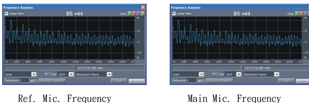
圖 3.16 PH-1 麥克風收音防振橡膠墊改善實驗一頻率響應圖
