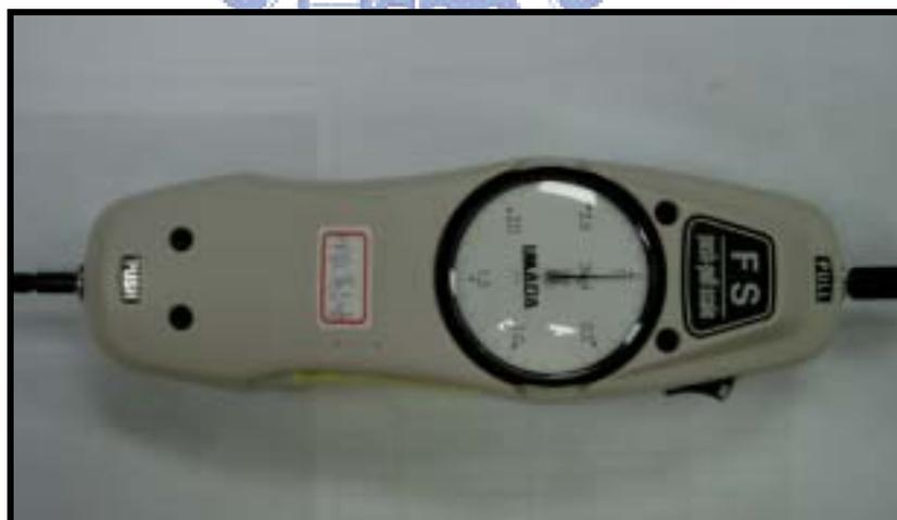
圖 3-11 50kg 推拉力試驗機
