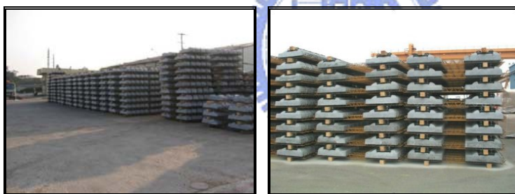
圖 4-70 預鑄軌枕儲存場(一) 圖 4-71 預鑄軌枕儲存場(二)
