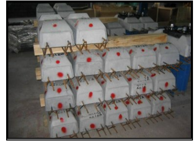
圖 4-58 不合格軌枕區隔存放
