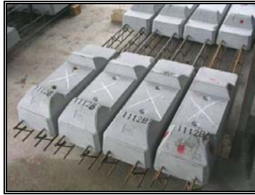
圖 4-57 不合格軌枕標示
