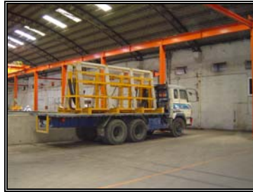
圖 4-36 軌道版搬運板車
