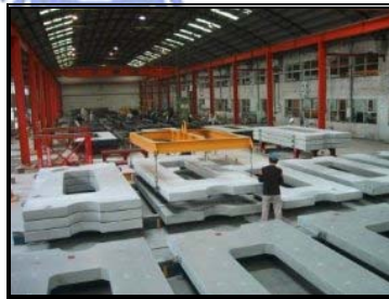
圖 4-25 軌道版吊運至檢查區
