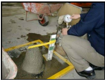
圖 4-21 混凝土現場試驗
