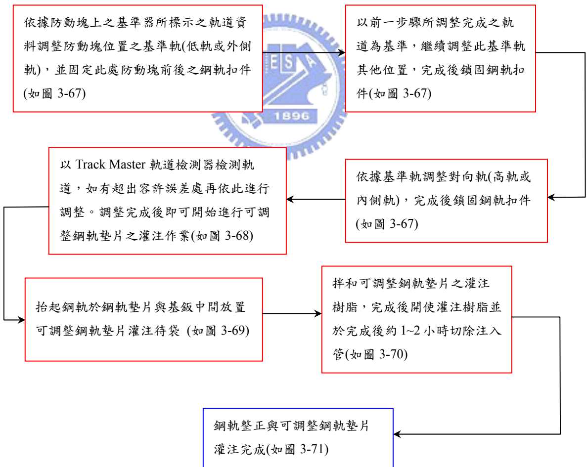
圖 3-66 日本 AF-55 版式軌道軌道整正與可調整鋼軌墊片灌注流程图
