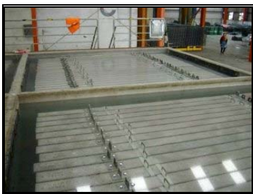
圖 4-33 軌道版浸水養生(一)
