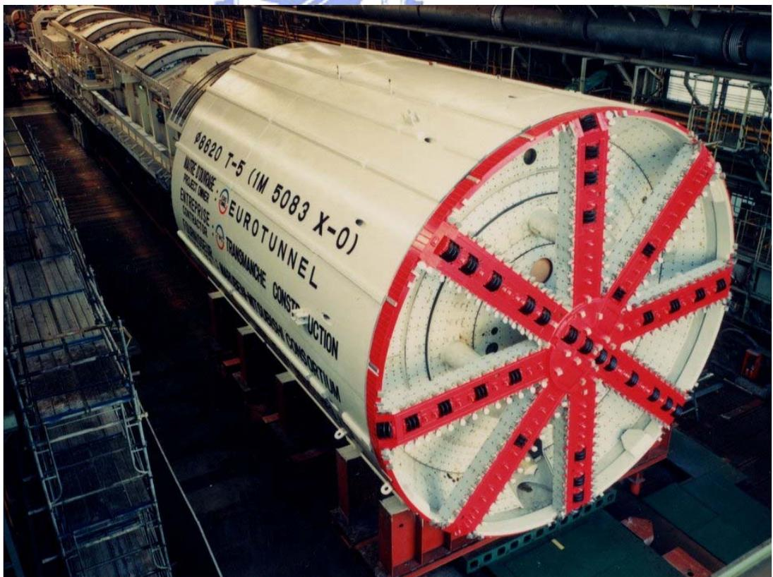
圖 167 1989 年英法海峽隧道工程採用之三菱重工株式會社-泥水壓式潛盾
