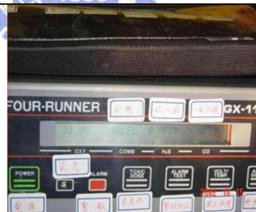
圖 161 隧道內有害氣體偵測
