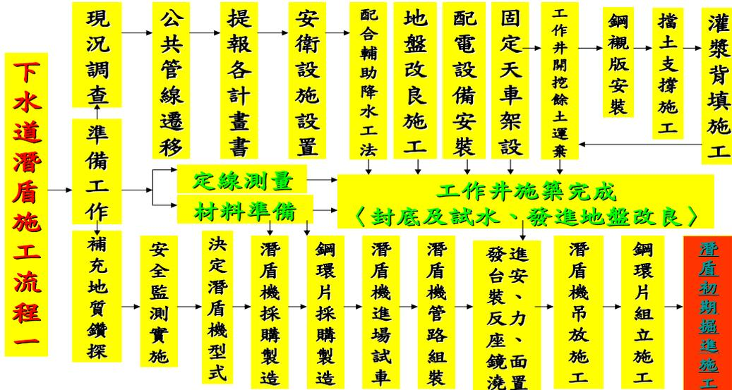
圖 127 說明下水道潛盾施工至初期掘進(含安衛) 作業流程圖一
