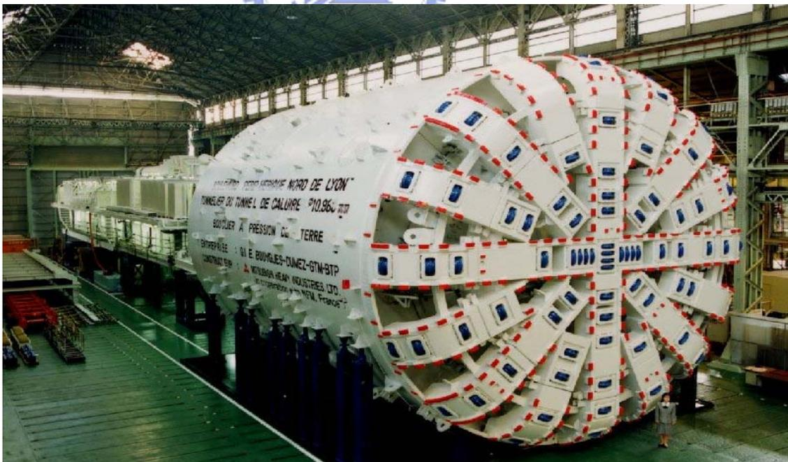
圖 169 1992 年 7 月法國里昂市高速公路隧道工程採用三菱重工株式會社之土壓式潛盾機 外徑  $\phi 10960\text{mm}$
