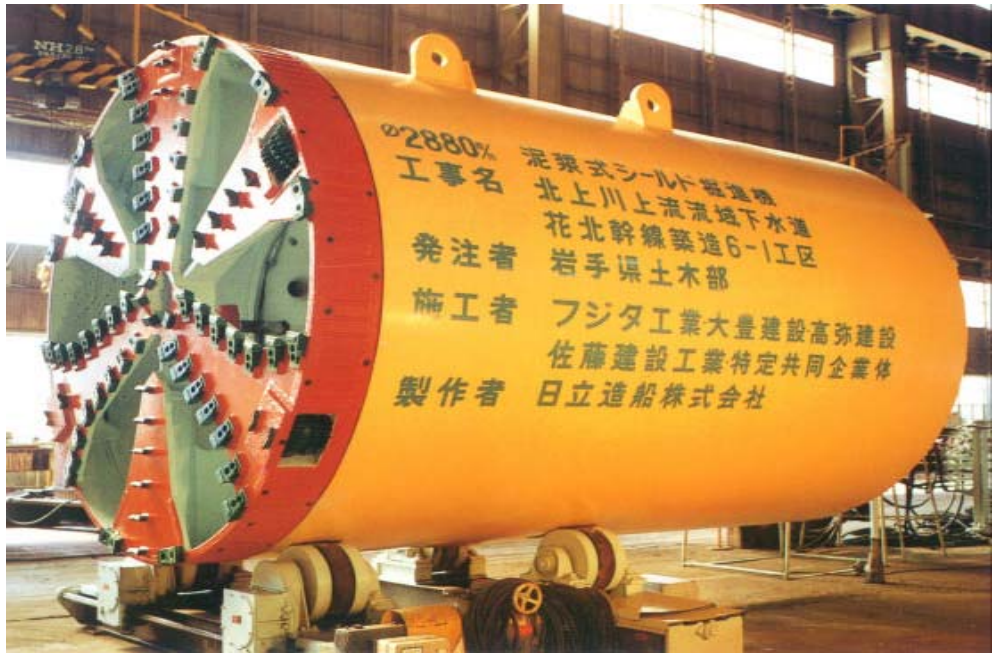
圖18 附切削齒之切刀盤適合切削卵礫石及流木 資料來源：(after Hitachi Zosen, 1990)〔40〕
