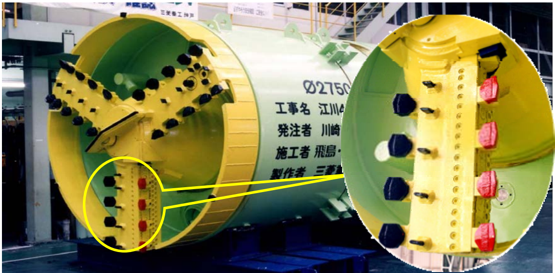
圖 48 日本川崎市雨水幹線採用之加泥土壓平衡式潛盾機
