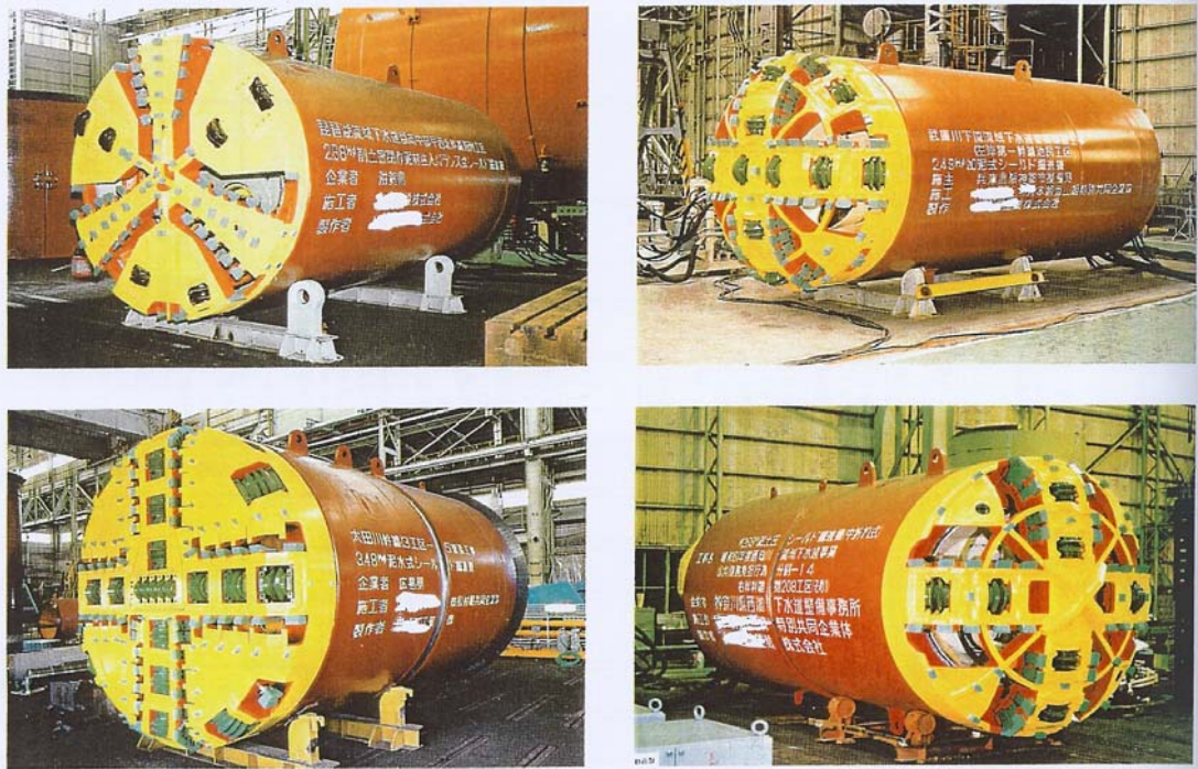
圖 51 適用於卵礫石層之各式潛盾機
