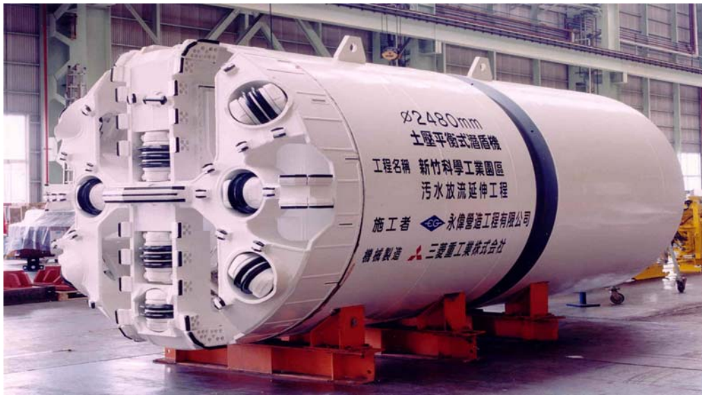
圖 47 竹科採用日本三菱重工業株式會社之土壓平衡式潛盾機
