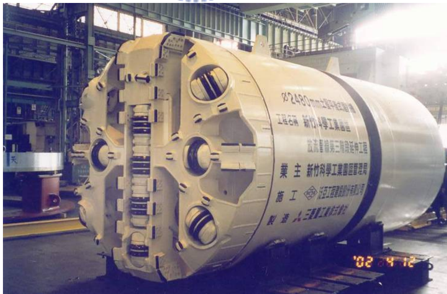
圖 43 竹科採用日本三菱土壓平衡式潛盾機
