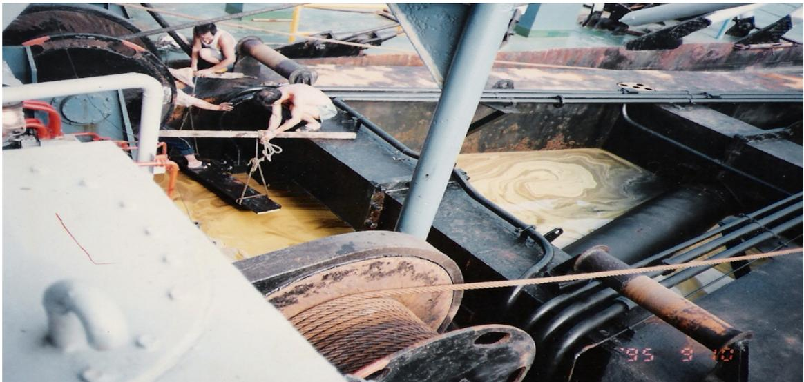
圖 5-12 挖到障礙物時液壓油管爆管洩油實體圖
