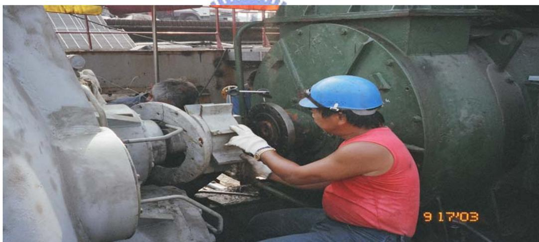
圖 5-16 挖泥船傳動軸檢修圖
