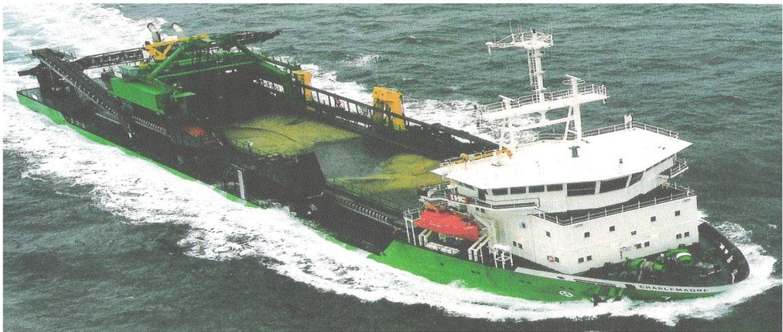
圖 3-3 利用挖泥船本身之船艙輸送泥沙情形（資料來源：IHC HOLLAND）
