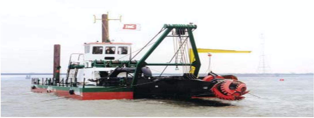
圖 3-23 絞刀抽吸式挖泥船實體圖 (資料來源：IHC HOLLAND)
