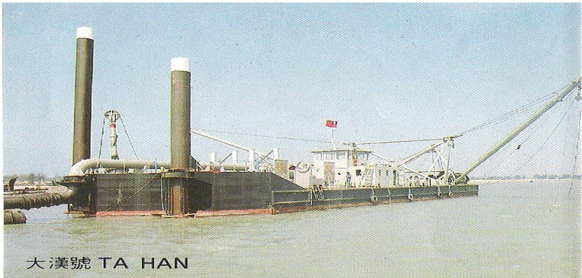
圖 3-10 榮工處大漢號挖泥船實體圖
