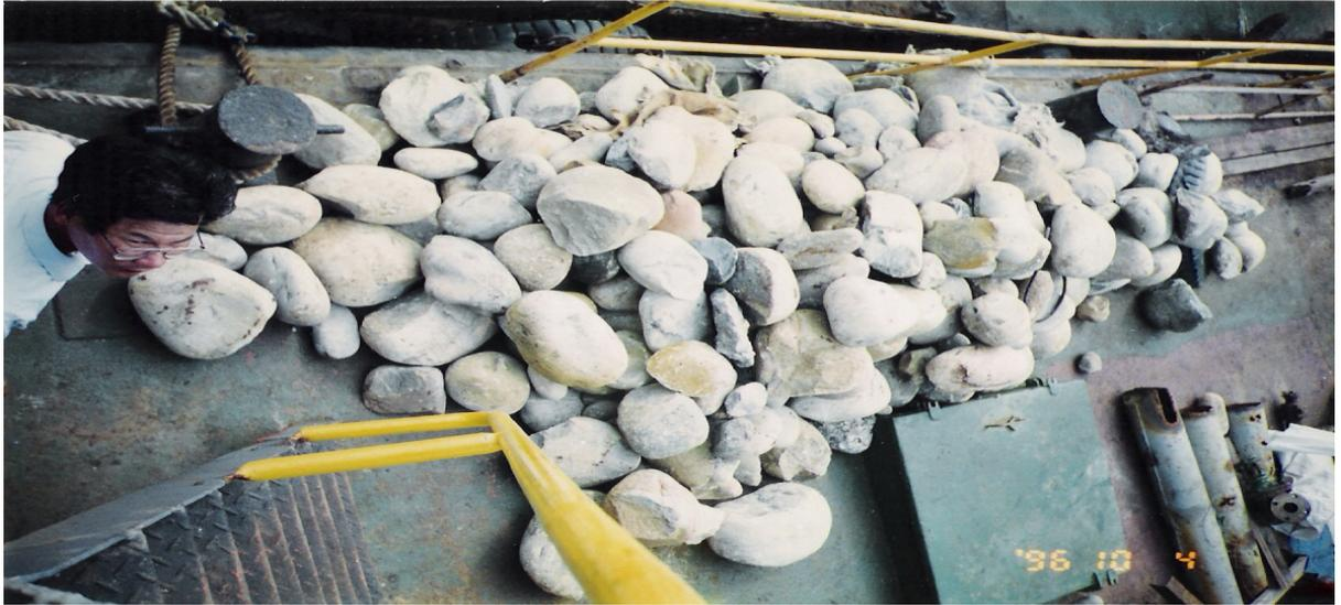
圖 5-11 挖泥作業時挖到 40 公分以上大石頭實體圖
