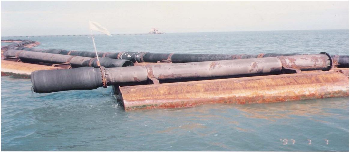
圖 5-21 海上管橡皮接頭斷裂實體圖
