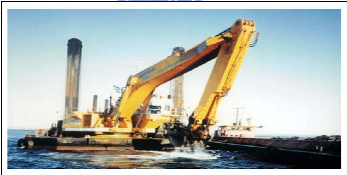
圖 3-21 背儲式挖泥船實體圖 (資料來源：IHC HOLLAND)
