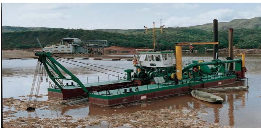
圖 3-1 挖泥船在水底下浚挖泥砂情形（資料來源：IHC HOLLAND）
