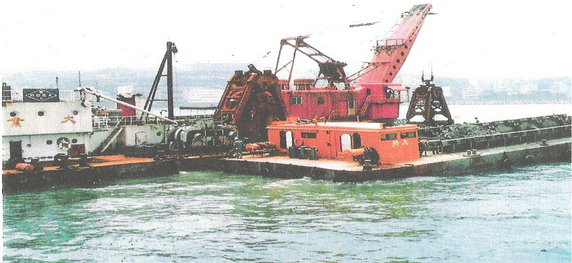
圖 3-4 利用受泥船輸送泥沙情形
