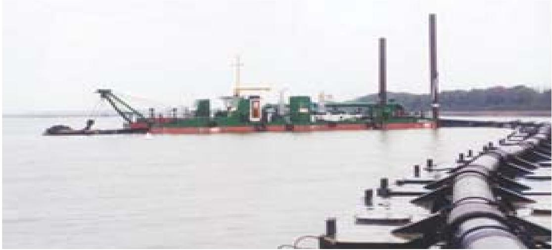
圖 3-2 挖泥船利用排泥管線輸送泥沙情形（資料來源：IHC HOLLAND）
