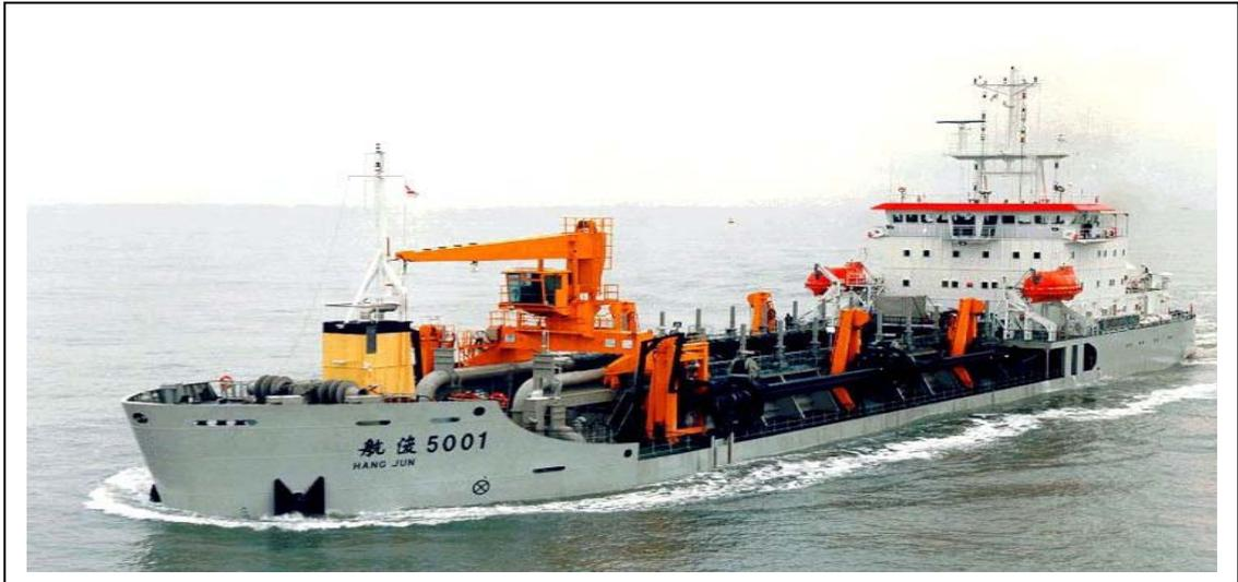
圖 3-25 自航抽吸式挖泥船實體圖（資料來源：IHC HOLLAND）
